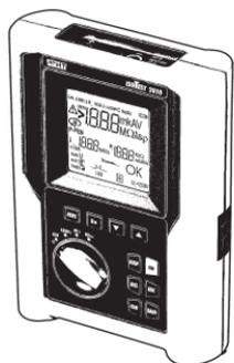
Possono essere: a bobine incrociate con generatore elettromeccanico incorporato ad azionamento manuale, oppure, nelle versioni più moderne, con alimentazione da batterie interne. Appartengono a questi tipi di strumenti anche i misuratori della resistività del terreno e della resistenza di un impianto di terra.
