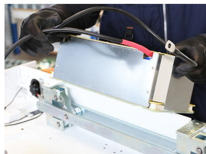
Con una chiave (E) di adeguate dimensioni, svitare le viti (F) di fissaggio del condensatore (G) e toglierlo dalla macchina. Sostituirlo con uno di uguali caratteristiche procedendo alle operazioni inverse per il rimontaggio.
