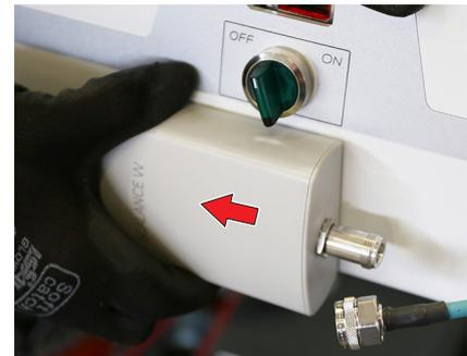
Svitare il connettore (A) del cavo di collegamento all'antenna (B); sfilare l'antenna come indicato dalla freccia.
