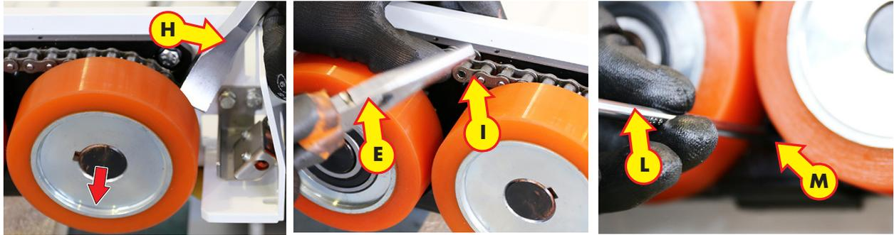
Aiutarsi con una chiave (H) facendo leva per disimpegnare la ruota dall'albero. Con l'utilizzo della pinza a becchi (E), disimpegnare la catena (I).
