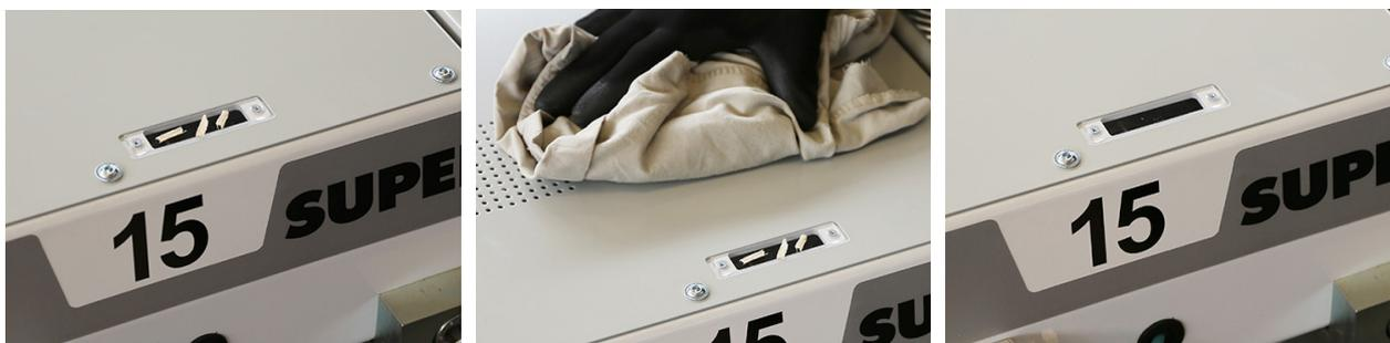
L'operatore deve verificare che tutte le specole visive delle fotocellule "H1" e "H2" siano pulite. Non è possibile indicare scadenze periodiche, in quanto la necessità della pulizia è legata all'utilizzo della macchina ed a eventi accidentali. È comunque consigliabile controllare ad ogni carico in corsia del satellite l'assenza di residui che potrebbero comprometterne il corretto funzionamento.
