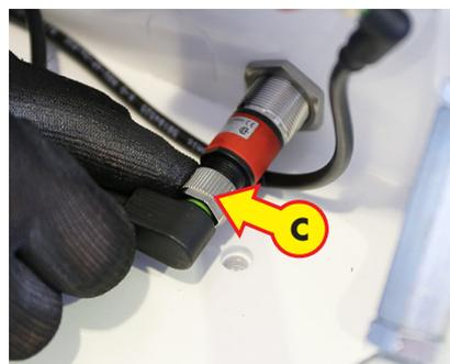
Con l'utilizzo di una chiave a brugola di dimensioni adeguate, rimuovere tutte le viti di fissaggio (A) del carter superiore della macchina. Rimuovere il carter superiore (B). Svitare il connettore (C) del sensore di rilevamento veicolo.
