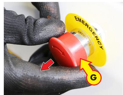
Con l'utilizzo di una chiave allentare le viti (E) di fissaggio del blocchetto (F) e ruotarlo successivamente in senso antiorario per disimpegnarlo. Sfilare il pulsante di emergenza (G) e sostituirlo con uno dello stesso tipo. Rimontare seguendo le operazioni inverse.
