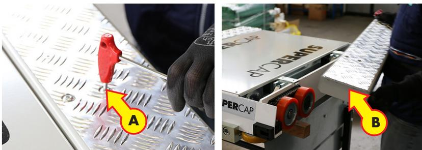
Togliere tutte le viti (A) di fissaggio del piano mobile. Sollevare il piano mobile (B) e sostituirlo con uno dello stesso tipo e dimensione.
