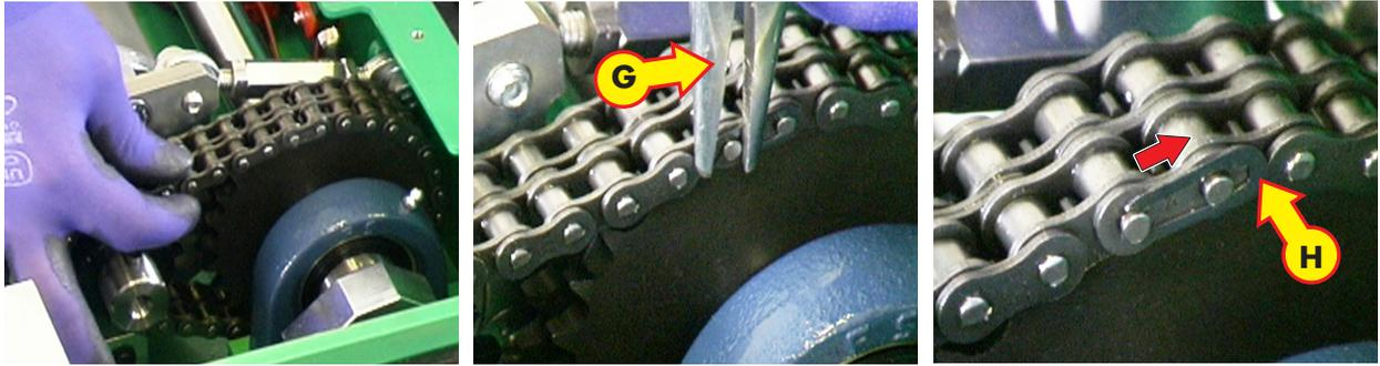
Verificare successivamente che la catena sia allentata. Individuare la falsa maglia della catena e con l'utilizzo di una pinza a becchi (G), rimuovere la maglia di giunzione (H).
