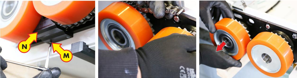
Utilizzando una chiave a brugola (L), di adeguate dimensioni, svitare le viti (M) di fissaggio del supporto di scorrimento catena (N) e rimuoverlo. Rimuovere la catena e sfilare le ruote dall'albero.
