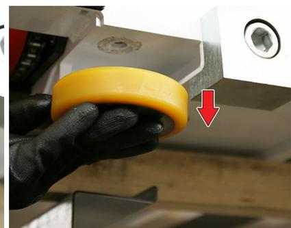
Con l'utilizzo di una chiave di adeguate dimensioni (A), svitare la vite di fissaggio (B) della ruota sostituendola con una nuova dello stesso tipo.
