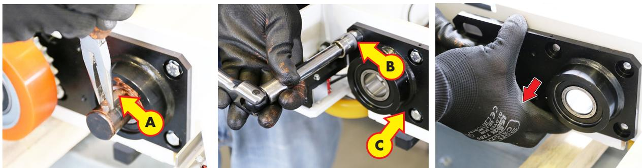
L'operatore dovrà mediante una pinza, togliere la chiavetta (A) situata nello spacco dell'albero. Successivamente con l'utilizzo di una chiave di adeguate dimensioni, dovrà togliere le viti (B) di fissaggio del supporto (C) fissato al telaio della macchina. Sfilare il supporto dall'albero.
