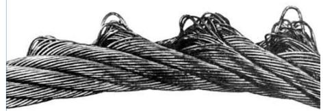
Incremento locale del diametro di una fune ad avvolgimento parallelo, determinato da distorsione dell'anima metallica, derivante da un carico improvviso. Si notano pure tracce di corrosione e forte usura dei fili esterni. Tale condizione richiede l'immediata sostituzione.
