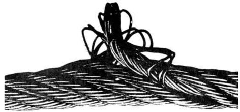
Un solo trefolo è interessato da espulsione di fili, sebbene l'esame su un tratto di fune mostri che la deformazione è visibile ad intervalli regolari, normalmente pari al passo di avvolgimento. Occorre tenere sotto controllo tale difetto.
