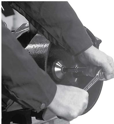
4. Estrarre il mozzo mediante un estrattore assieme a tre ganasce.
