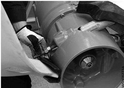
7. Ingrassare le filettature della vite e sistemare le due rondelle piccole sopra la vite.
