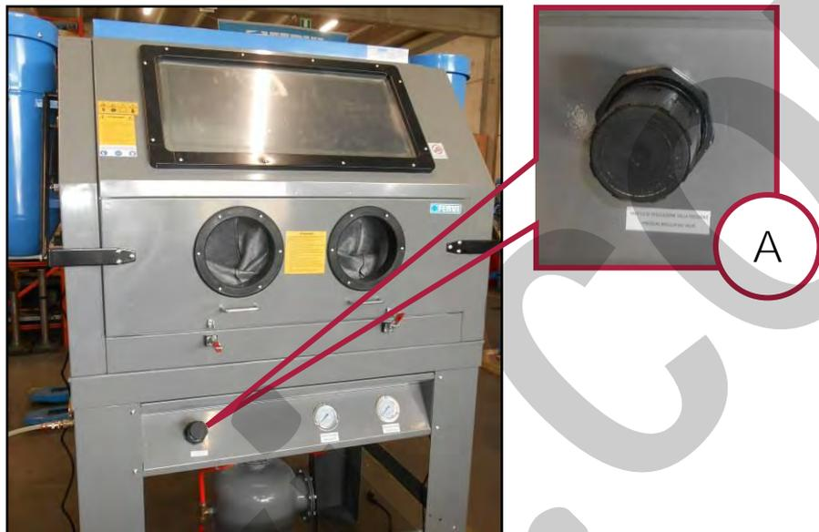
Figura 20 – Valvola di pressione e manometro.
