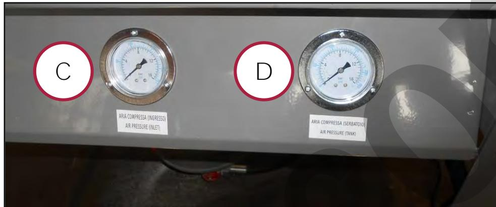
Figura 22 - manometri controllo pressione aria compressa.
