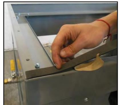
Figura 10 - Montaggio isolante sulla staffa.
