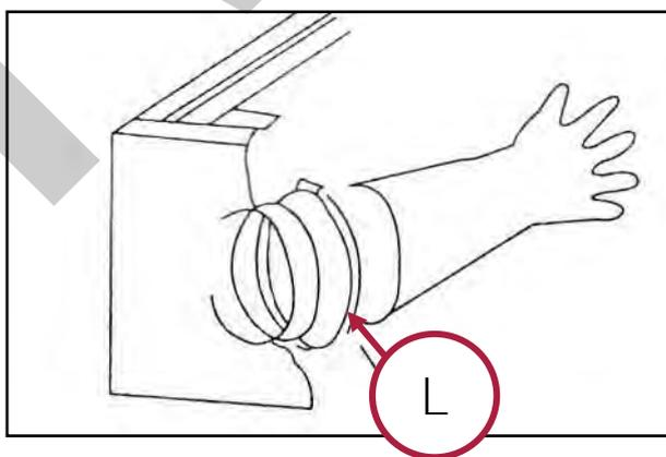
Figura 31 – Sostituzione dei guanti.
