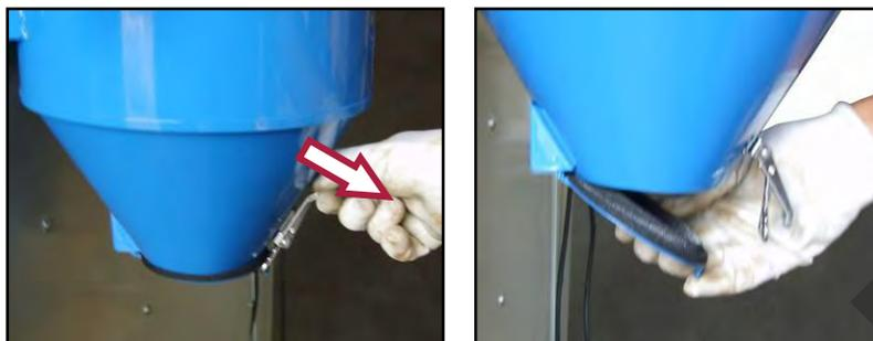
Figura 34 – Aprire il coperchio per scaricare la polvere.
