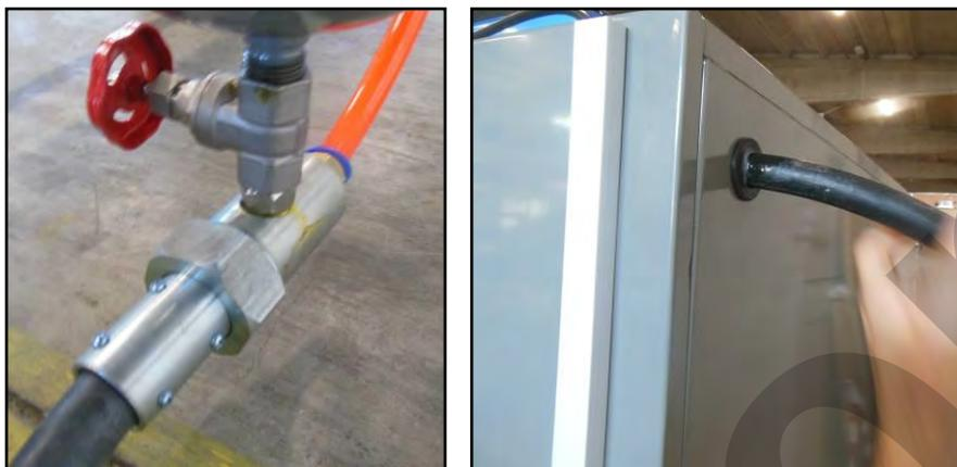
Figura 17 - Collegamento tubo da serbatoio dell'abrasivo alla cabina.
