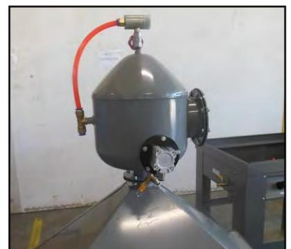
Figura 11 - collegamento del serbatoio dell'abrasivo alla tramoggia.
