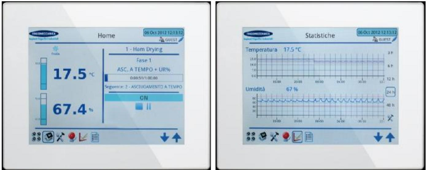
Lo strumento è dotato di una scheda di controllo di processo (CPU) a cui possono essere collegate le necessarie schede di espansione. Alla CPU è collegato un display touch-screen a colori retroilluminato a led con risoluzione 800 x 600 PIXEL, tramite il quale è possibile effettuare la lettura dei valori istantanei di temperatura e di umidità ambiente, dei parametri funzionali dei gruppi frigoriferi ed il numero del programma e della fase.
