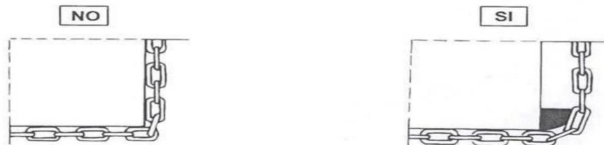
Figura4–Spessori per evitare danneggiamenti della fune o della catena
