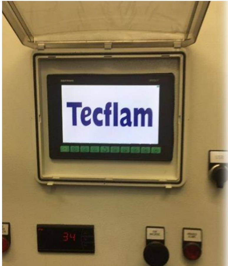
Il PLC controlla il funzionamento del forno e consente di modificare ed impostare, sia in locale che in remoto mediante idonea interconnessione a gestionale di produzione, i dati seguenti:
