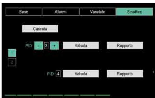
La pagina 1 della sezione Sinottico permette di impostare il tipo di funzionamento del PID: normale, in cascata, valvola motorizzata o regolazione a rapporto fisso.
