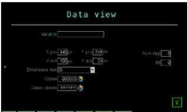
Questa pagina permette di configurare i parametri del campo predisposto alla sola visualizzazione di un dato di tipo numerico. I parametri disponibili sono:
