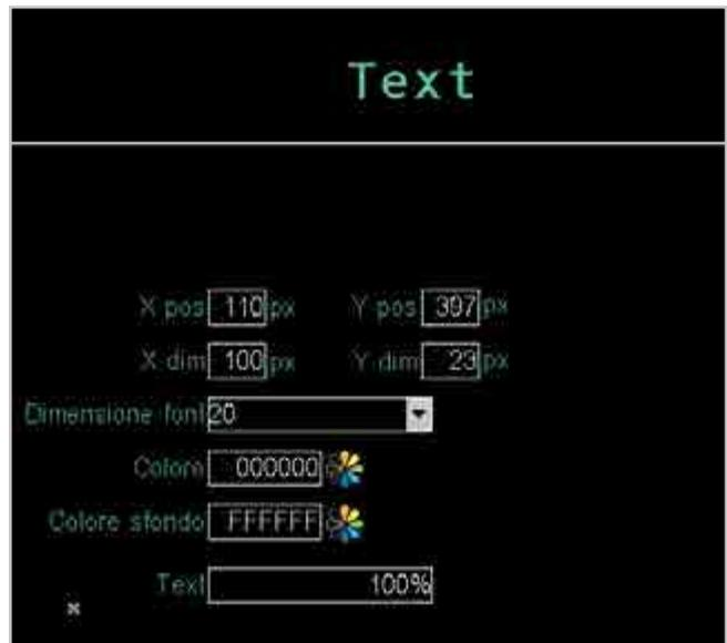
Inserire un componente Text e configurarne i parametri per la visualizzazione dell'etichetta relativa al fondo scala del Bar Graph OUT del PID1.
