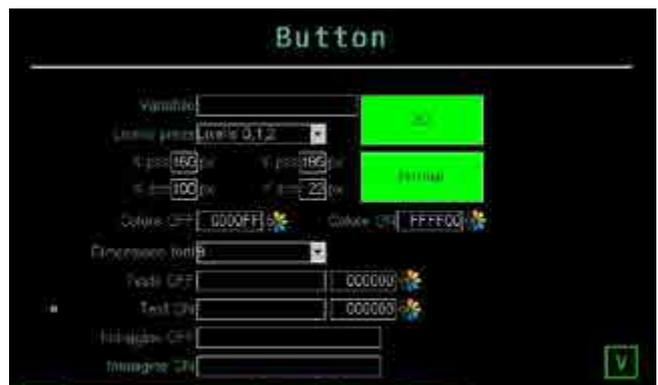
Questa pagina permette di configurare i parametri del componente pulsante, che permette di visualizzare e forzare lo stato di un dato digitale. I parametri disponibili sono:
