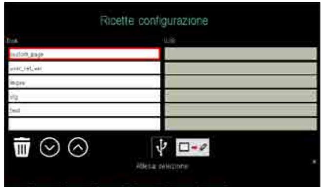
La pagina **Ricette configurazione** permette di trasferire le configurazioni dal regolatore a una chiavetta USB e viceversa, o cancellarle. In questo modo è possibile clonare una configurazione tipo su altri regolatori o effettuare una copia di back-up della configurazione corrente, sia per sicurezza sia per precauzione prima di effettuare modifiche su una configurazione funzionante.
