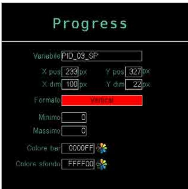
Inserire un componente Bar Graph e configurarne i parametri per la visualizzazione del valore SP del PID1. Si noti come i valori Xdim, Ypos e Ydim siano uguali a quelli del componente Bar Graph per PV.
