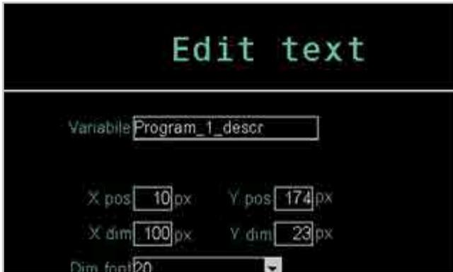
Inserire un componente Text e configurarne i parametri per la visualizzazione dell'etichetta relativa all'inizio scala del Bar Graph OUT del PID1.
