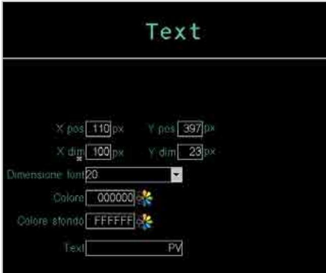
Inserire un componente Text e configurarne i parametri per la visualizzazione dell'etichetta PV.
