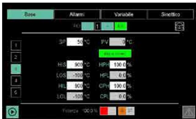
La pagina Base 3 permette di configurare i limiti del PID.
