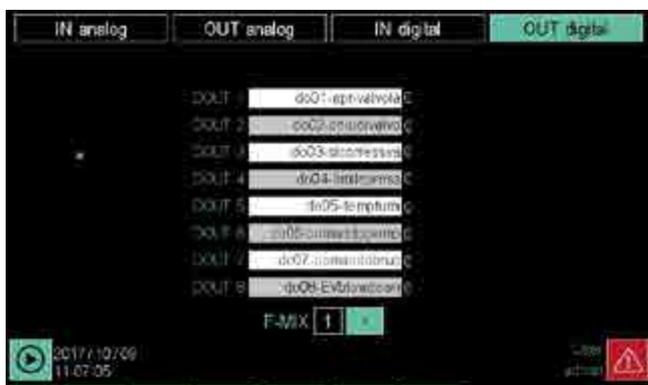
Sono elencate tutte le uscite digitali del modulo, una per riga. Ogni uscita è identificata dal suo numero progressivo, che corrisponde a quello riportato nello schema del connettore del modulo (vedere il paragrafo “2.8. Schema connessioni modulo I/O digitali F-EU16” a pagina 29).
