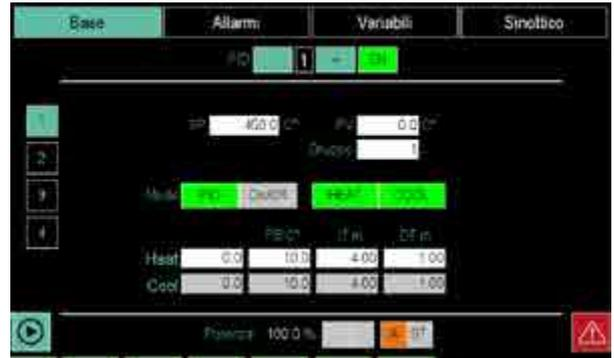
Con i parametri visualizzati è possibile configurare le azioni del regolatore PID.
