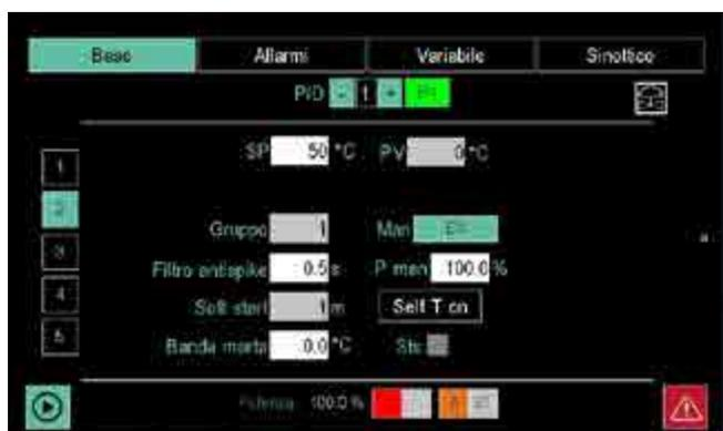
La pagina Base 2 permette di configurare i parametri avanzati del PID.
