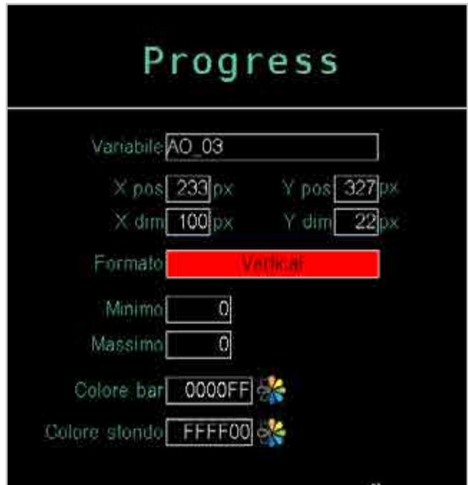
Inserire un componente Bar Graph e configurarne i parametri per la visualizzazione del valore OUT del PID1. Si noti come i valori Ypos e Ydim siano uguali a quelli del componente Bar Graph per PV.
