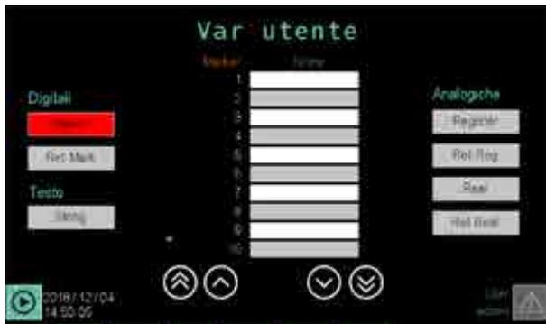
Selezionare l'elenco delle variabili di tipo "Register" toccando il tasto **Register** della sezione Analogiche. Configurare nella prima riga vuota il nome di variabile "Valore\_medio". Nella colonna D.P. (punto decimale) impostare 1
