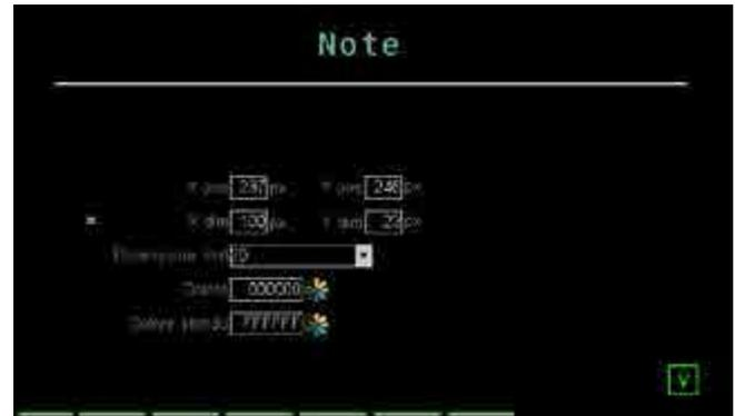
Questa pagina permette di configurare i parametri di un componente atto a contenere del testo inserito direttamente dalla pagina grafica. L'operatore può quindi inserire note e descrizioni personalizzate, ad esempio un'indicazione per l'operatore successivo. Il testo inserito viene salvato allo spegnimento del regolatore. I parametri disponibili sono:
