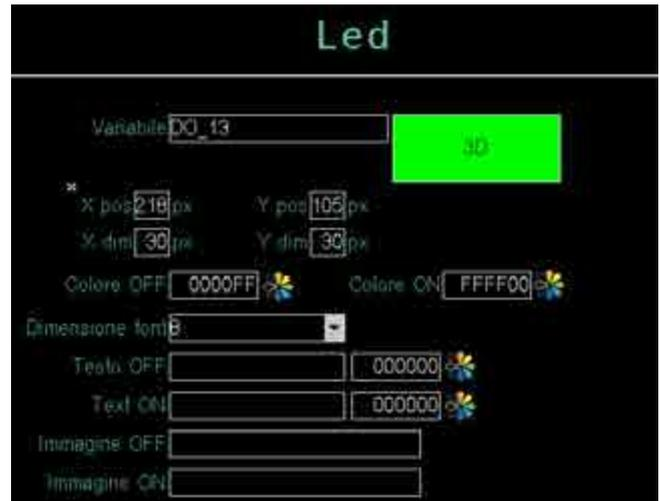
Inserire un componente Led e configurarne i parametri per la visualizzazione del valore dello stato uscita di controllo COOL del PID1. Si noti come i valori Xdim, Xpos e Ydim siano uguali a quelli del componente LED uscita di controllo HEAT.
