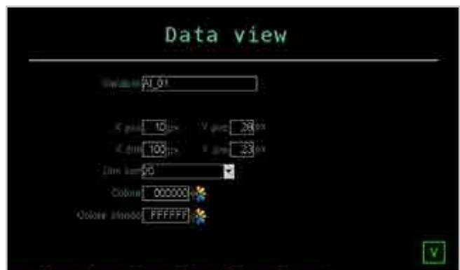
Configurare i parametri del componente Data View (4) per la visualizzazione del valore PV del PID1.
