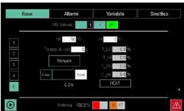
La pagina Valve permette di configurare il controllo di una valvola. Questa tipologia di controllo è compatibile sia con la regolazione in cascata che con quella di rapporto. La pagina appare solo se per il PID, nella sezione Sinottico, è stato impostato il funzionamento Valve (valvola).
