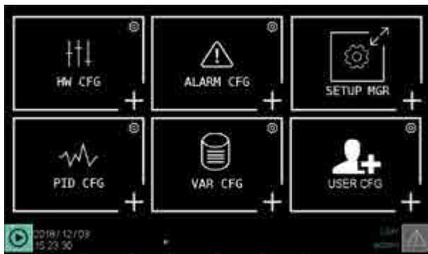
10. Selezionare **PID CFG** per accedere alla configurazione parametri regolatore PID.
