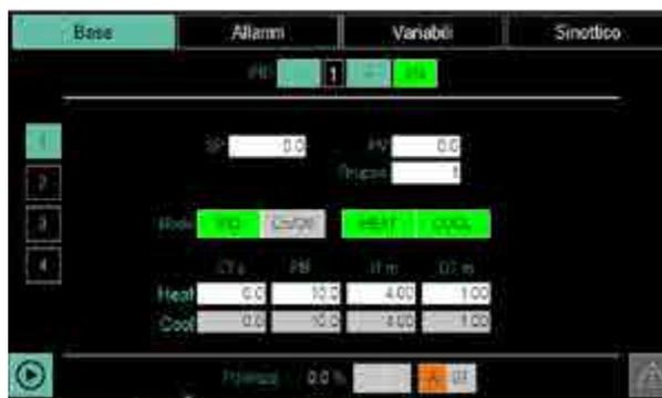
11. Selezionare **Sinottico** per accedere alla pagina di configurazione tipologia di controllo PID.
