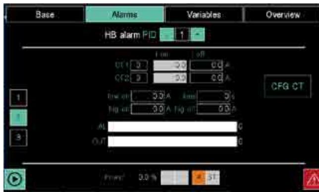
La pagina HB alarm permette di configurare i parametri degli allarmi HB del PID. Per aprire la pagina degli allarmi fare doppio click sul pulsante **Allarmi** e nel menu a tendina che si apre selezionare **HB**. La pagina HB si può aprire, dalle altre pagine della sezione Allarmi, anche toccando il pulsante 2 a sinistra.
