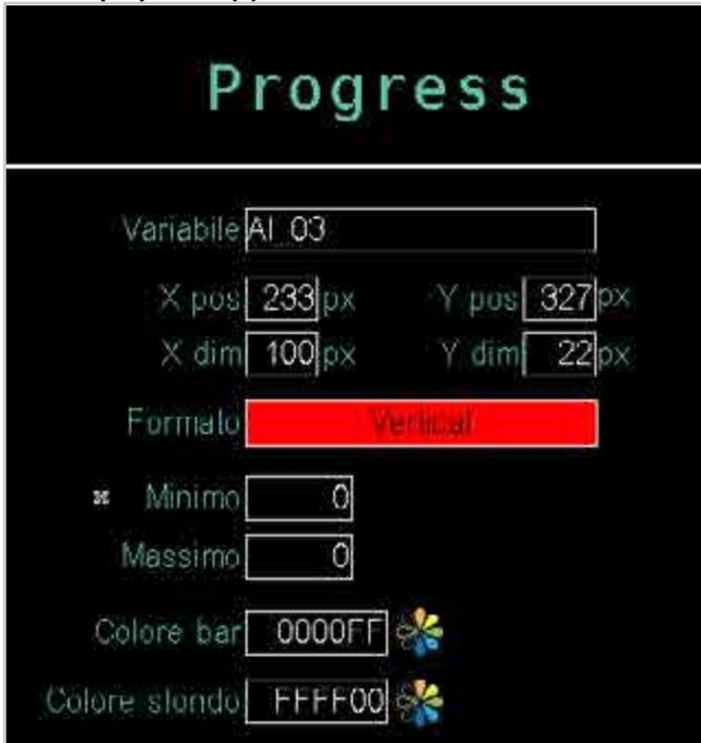
Inserire un componente Bar Graph e configurarne i parametri per la visualizzazione del valore PV del PID1.
