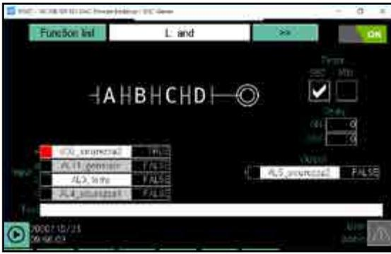
inserire il nome o la descrizione della funzione che apparirà in elenco. Toccando il campo si apre una tastiera virtuale con cui è possibile scrivere il nome o la descrizione. Il testo immesso può essere lungo fino a 34 caratteri nel modello 2850T e fino a 42 caratteri nel modello 3850T.
