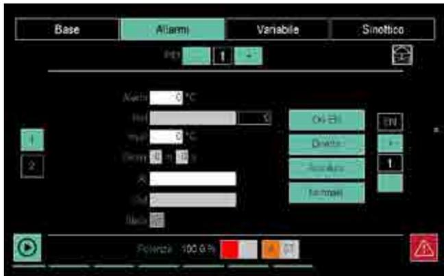
La sezione Allarmi permette di configurare i parametri degli allarmi del PID. Per aprire la pagina degli allarmi fare doppio click sul pulsante **Allarmi** e nel menu a tendina che si apre selezionare **Allarmi**. La pagina Allarmi si può aprire, dalle altre pagine della sezione Allarmi, anche toccando il pulsante 1 a sinistra.
