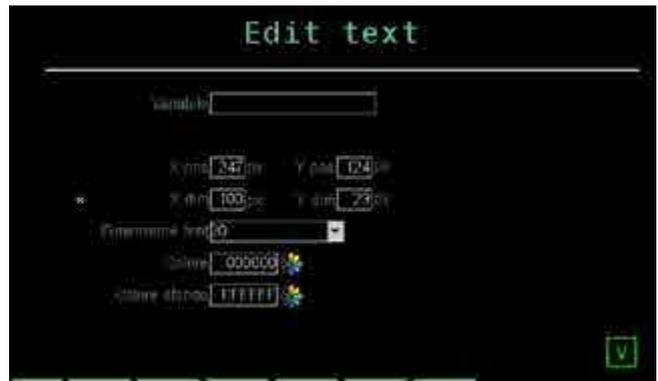
Questa pagina permette di configurare i parametri del campo predisposto alla visualizzazione e modifica di un dato di tipo numerico, ad esempio un setpoint. I parametri disponibili sono:
