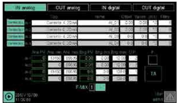
Toccare **IN1 Tipo** e selezionare **TC\_K** (termocoppia K). La variabile predefinita associata al valore di temperatura del canale 1 è AI\_01.
