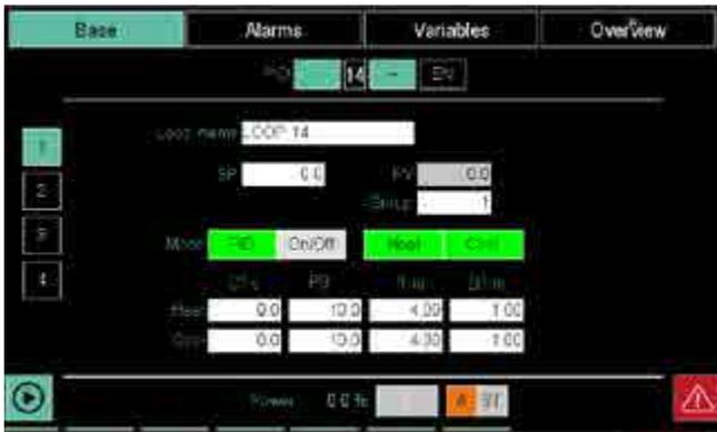
La sezione Base permette di configurare i parametri base del PID. Per aprire la pagina dei parametri base fare doppio click sul pulsante **Base** e nel menu a tendina che si apre selezionare **Base**. La pagina Base si può aprire, dalle altre pagine della sezione Base, anche toccando il pulsante 1 a sinistra.
