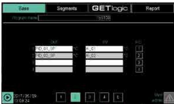
Eliminare da colonna “OUT” e “PV” le variabili delle righe 3 e 4. In questo modo verranno generati solo i profili di SP per 2 curve.
