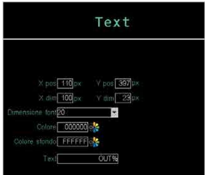
Inserire un componente Text e configurarne i parametri per la visualizzazione dell'etichetta OUT.
