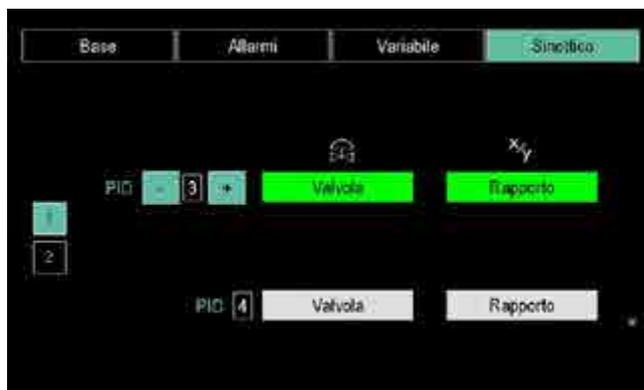
La pagina 2 (PID overview) mostra i tipi di funzionamento configurati per tutti i PID.
