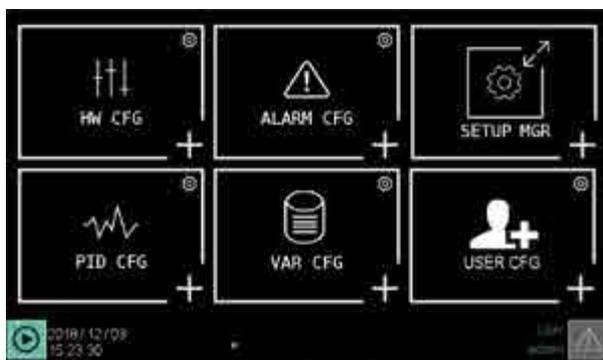
8. Selezionare **ALARM CFG** per accedere alla configurazione messaggi di allarme.
