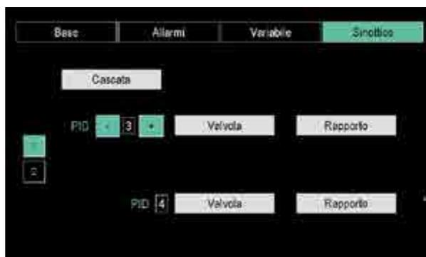
Il tipo di funzionamento predefinito è controllo PID base. PID base significa che non sono abilitati i PID Cascata, Valvole o Rapporto.
