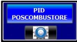
Premere il tasto per entrare nei parametri PID della camera di postcombustione. ( in questa
