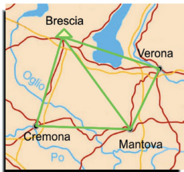
Geometria della rete demo-test. Tutte le stazioni inviano il segnale proveniente dalla costellazione satellitare GPS alla stazione di controllo dell'Università degli Studi di Brescia.
