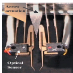
Fig. 13. Rappresentazione della micropinza complessiva con particolare attenzione rivolta alla posizione dei sensori ottici e della "freccia" [5] e vista di lato. Si può notare l'angolo di 30^\circ che facilita il compito di afferraggio ed assemblaggio di microcomponenti [14].
