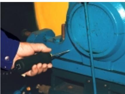
I dati sulla velocità sono necessari per la valutazione della condizione operativa, e il monitoraggio della temperatura della macchina spesso fornisce un'informazione preziosa. Il T30 utilizza le sonde di temperatura per solidi e liquidi. La velocità viene misurata a contatto, o con sistema ottico ad una distanza di sicurezza.
