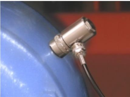
Speciali trasduttori per shock pulse e vibrazioni assicurano misure attendibili. Sui punti di misura che sono inaccessibili durante le normali operazioni, i trasduttori sono installati in modo permanente e collegati ai terminali di misura.
