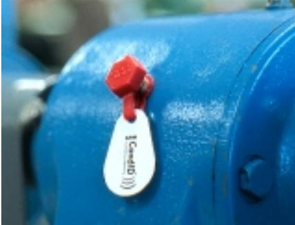
La più recente tecnica per risparmiare fatica: medagliette di identificazione senza contatto trasmettono allo strumento tutti i dati sui punti di misura, e salvano anche l'ultimo risultato. I dispositivi per la trasmissione in radiofrequenza, sono inclusi nelle versioni Logger e Expert del T30.
