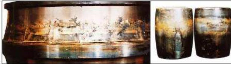
Fig. 48: Grippaggio per mancanza di lubrificazione; l'anello interno e i rulli sono bruniti e fusi, con residui della gabbia in ottone
