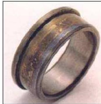
Fig. 22: Scheggiatura dell'orletto per carico eccessivo (cuscinetto a rulli cilindrici)
