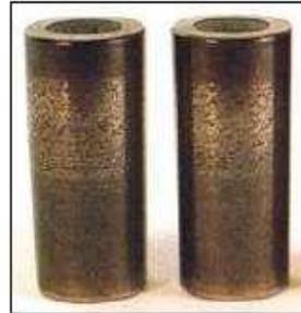
Fig. 37: Indentatura da particelle contenute nell'olio (rulli conici)
