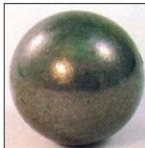
Fig. 46: Sfera “macchiata” da ammaccature (corpi estranei e cattiva lubrificazione)
