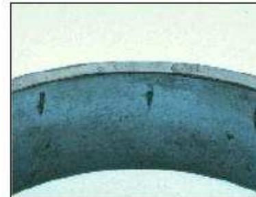
Fig. 42: Brinelling per forzatura eccessiva (anello esterno cuscinetto a rulli cilindrici)
