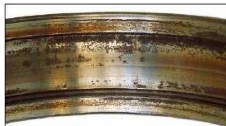
Fig. 54: Corrosione per acqua nel lubrificante (cusc. a rulli cilindrici)
