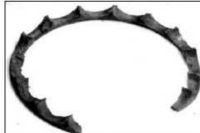
Fig. 71: Gabbia in poliammide rotta per usura e surriscaldamento (cuscinetto a sfere)
