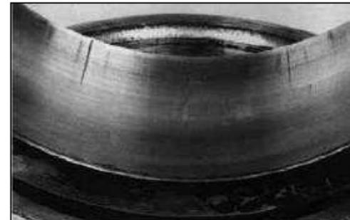
Fig. 26: Smerigliatura da inserimento forzato di gabbia e rulli (cuscinetto a rulli cilindr.)
