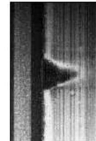
Fig. 43: Brinelling da urto (pista int. cusc. rulli cilindrici)
