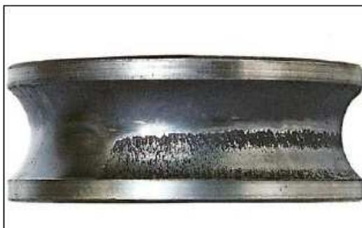
Fig. 16: Sfaldata per cattivo allineamento albero-supporto (cuscinetto radiale a sfere)
