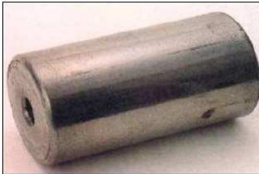
Fig. 21: Scalfiture in fase di montaggio (rullo cilindrico)
