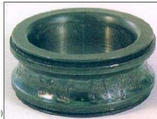
Fig. 15: Sfaldata per carico assiale eccessivo (cuscinetto radiale a sfere)
