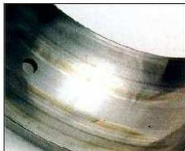
Fig. 45: Deposito di olio sulla pista esterna (cuscinetto orientabile a rulli)
