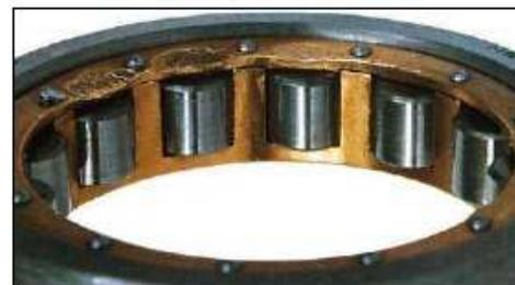
Fig. 69: Deformazione e rottura della gabbia in ottone per urto in fase di montaggio
