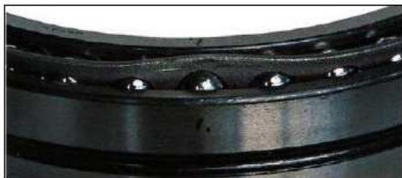
Fig. 68: Deformazione della gabbia in acciaio stampato per urto durante il maneggio (cuscinetto obliquo a sfere)
