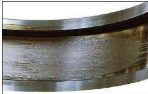
Fig. 25: Smerigliatura da slittamento per eccesso di grasso (cuscinetto a rulli cilindrici)
