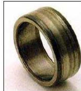
Fig. 31: Usura della pista per cattiva lubrificazione (cuscinetto a rulli cilindrici)
