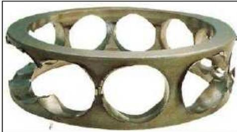
Fig. 70: Gabbia in ottone usurata, deformata e rotta per disallineamento del cuscinetto (cuscinetto obliquo a sfere)
