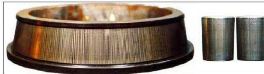
Fig. 62: Scanalature per corrosione elettrica (pista interna e rulli di un cuscinetto a rulli conici)
