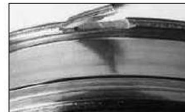
Fig. 57: Rottura del bordino (colpo di martello nel montaggio)
