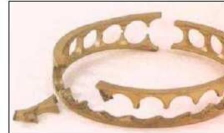
Fig. 72: Gabbia in ottone usurata e rotta per cattiva lubrificazione (cuscinetto obliquo a sfere)
