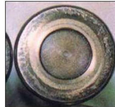
Fig. 23: Scheggiatura da cattiva lubrificazione (rulli conici)
