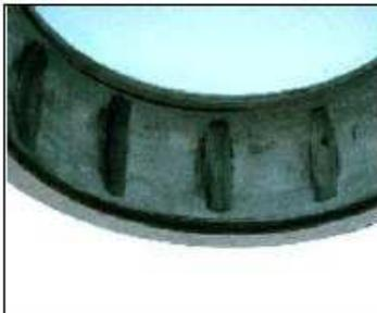
Fig. 40: Falso brinelling per vibrazioni e usura successiva (anello esterno cuscinetto a sfere)
