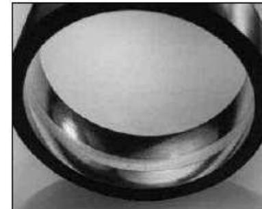
Fig. 32: Usura “a specchio” sull'anello esterno (cuscinetto orientabile a rulli)
