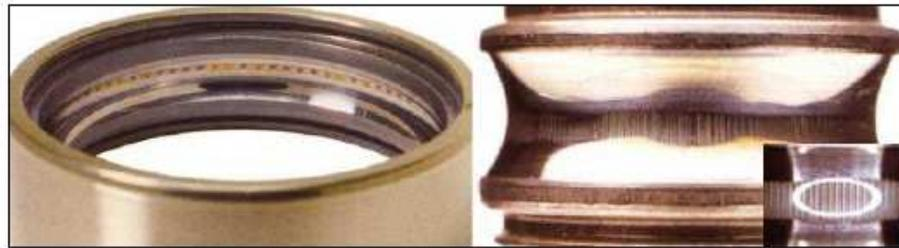
Fig. 67: Scanalature da corrosione elettrica causata da corrente ad alta frequenza (cuscinetto a sfere – in basso a destra ingrandimento della pista interna)
