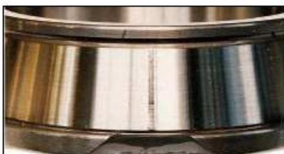
Fig. 58: Rottura del bordino (urto violento in fase di montaggio)
