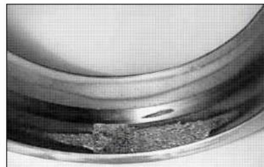
Fig. 17: Sfaldata per ovalizzazione dell'anello esterno (cuscinetto orientabile a rulli)
