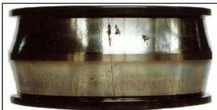
Fig. 55: Cricca assiale sull'anello interno per eccessiva temperatura albero
