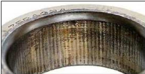
Fig. 33: Usura da sfregamento per calettamento lasco (cuscinetto obliquo a sfere)
