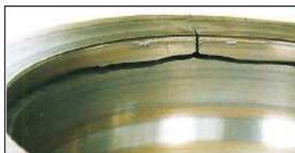
Fig. 59: Rottura per indebolimento causato da grave sfaldatura
