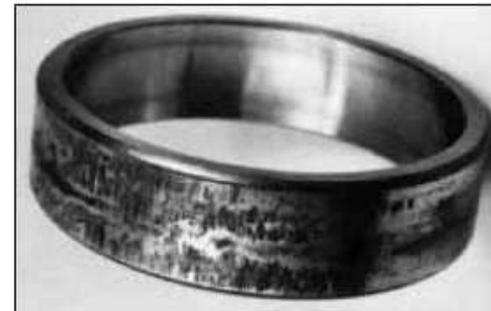
Fig. 28: Smerigliatura / riporto per slittamento nel supporto (cuscin. orientabile a rulli)
