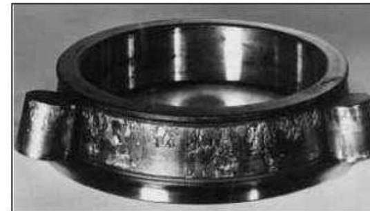
Fig. 49: Grippaggio per carico eccessivo e lubrificazione inadeguata
