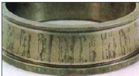
Fig. 53: Corrosione per acqua nel lubrificante (cuscinetto a rulli conici)
