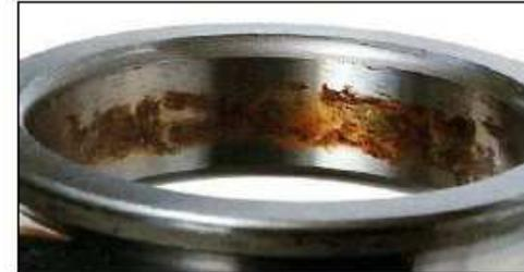
Fig. 35: Usura da sfregamento per vibrazioni (cuscinetto a sfere)
