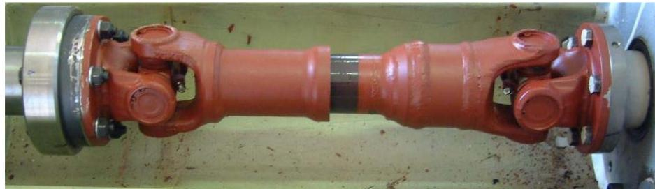
Figura 3- 23 Giunto cardanico motore elettrico- albero slave lento
