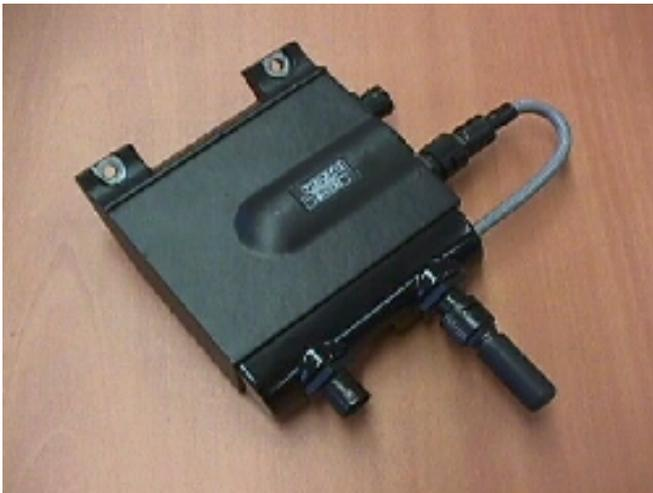
Questa opzione permette il controllo del COMBIMASTER da un bus seriale PROFIBUS-DP (SINEC L2-DP).
