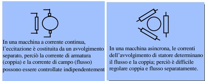
In una macchina a corrente continua, l'eccitazione è costituita da un avvolgimento separato, perciò la corrente di armatura (coppia) e la corrente di campo (flusso) possono essere controllate indipendentemente.
