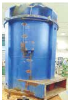
Revisione motore Officine Elettromeccaniche Trieste TP. MP. 670X 598CV
