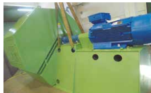
Revisione completa più equilibratura su motore Euromotori 200KW e Ventilatore IF1 KW200
