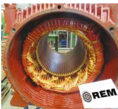
Ricostruzione avvolgimento statomico su motore Siemens TP1LA8405-4PB50-Z KW630
