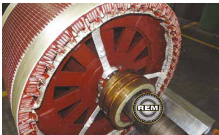
Ricostruzione avvolgimenti statomico e rotorico su motore Pellizzari TP. NUAV2000 HP 650
