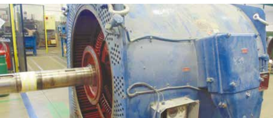
Ricostruzione avvolgimento statorico su motore Siemens TP1LA8405-4PB50-Z KW630
