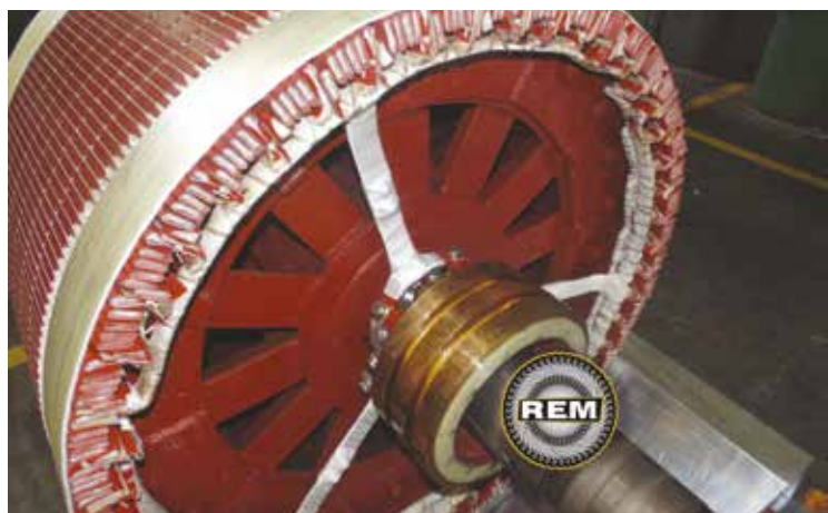
Ricostruzione avvolgimenti statorico e rotorico su motore Pellizzari TP. NUAV2000 HP 650
