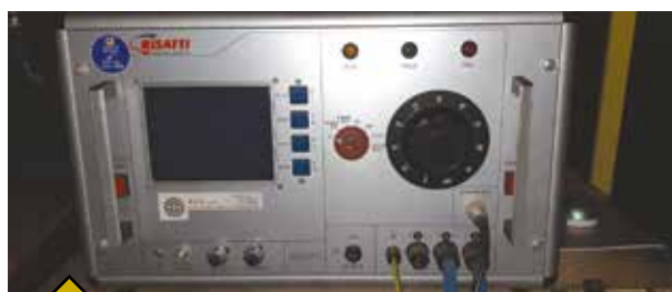
Surge-test per il Collaudo delle Macchine Elettriche
