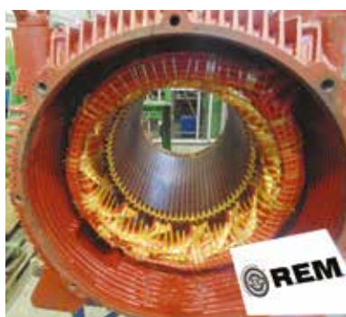
Ricostruzione avvolgimento statorico su motore Siemens TP1LA8405-4PB50-Z KW630
