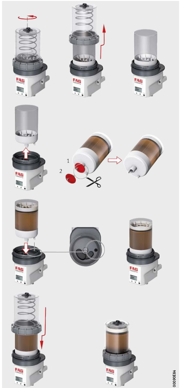
Bild 28 Kartusche wechseln
