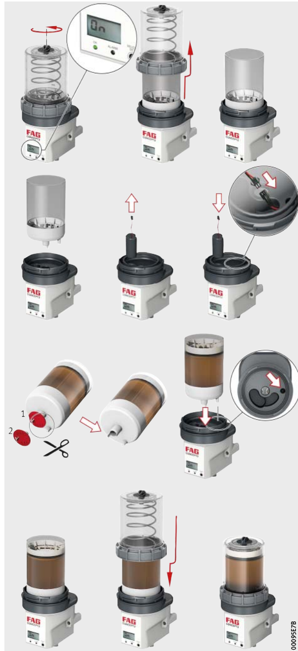
Bild 20 Kartusche und Batterie wechseln
