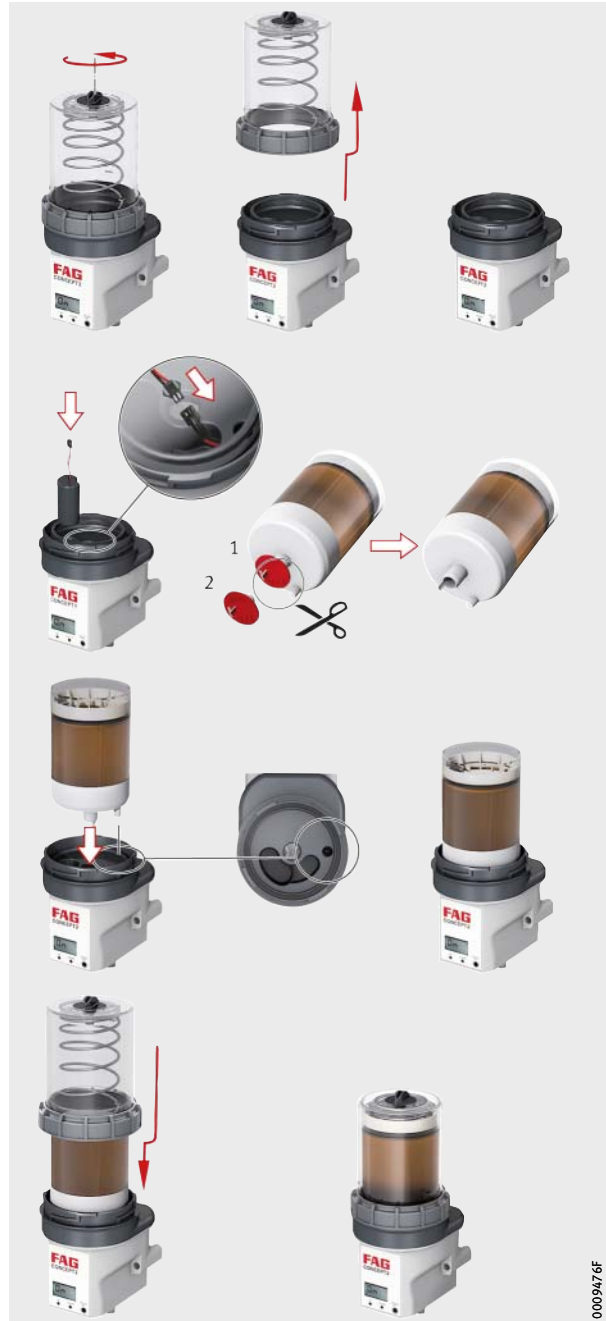
Bild 10 Batterie anschließen und Schmierstoffkartusche einsetzen
