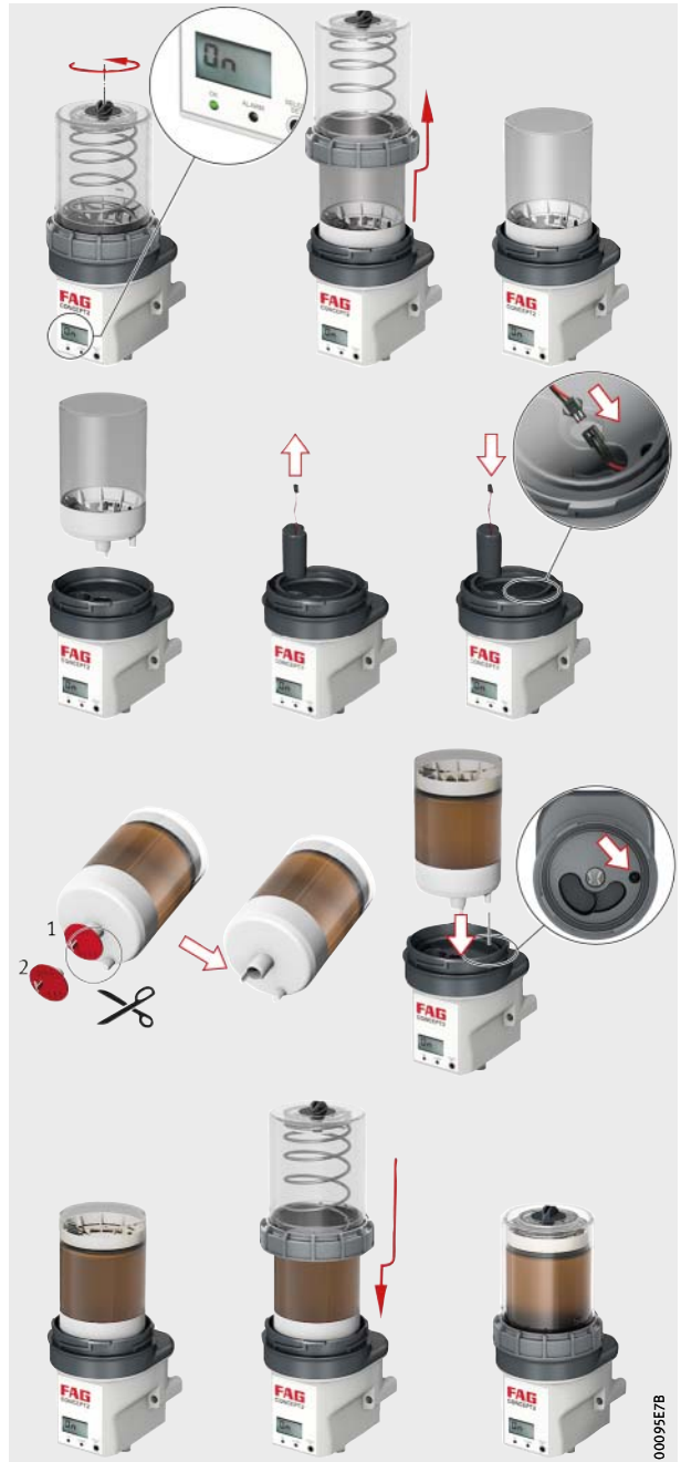
Bild 20 Kartusche und Batterie wechseln
