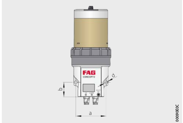
Bild 9 Montagemaße FAG CONCEPT2
