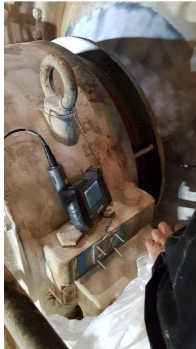
Diagnosi principio usura pista esterna cuscinetto monolucido cartiera
