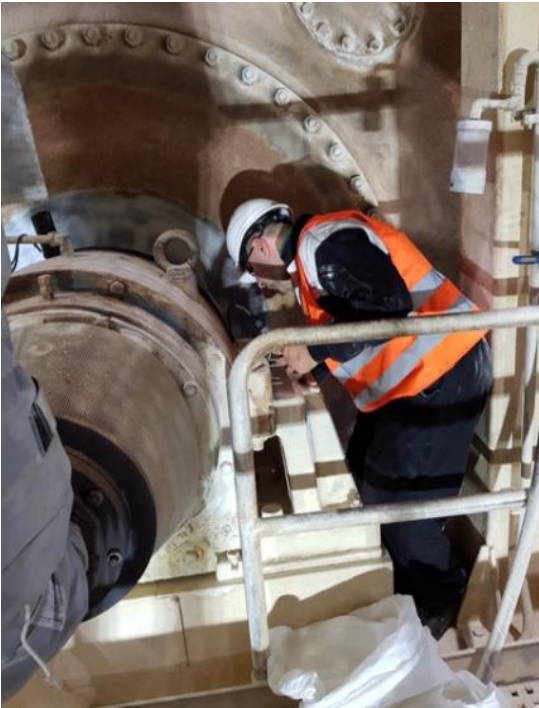
Diagnosi principio usura pista esterna cuscinetto monolucido cartiera
