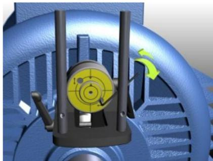
9. Controllare l'allineamento ruotando nuovamente la torretta di  $180^\circ$ . il laser non deve trovarsi sullo stesso punto fisso durante la rotazione (con un margine di 2 mm).
