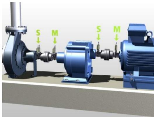
Cercare di stare sempre sullo stesso lato del treno di macchine in fase di montaggio dei sensori, per evitare di commettere errori.
