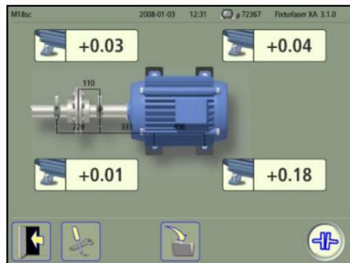
Lo schermo mostra i risultati della misurazione, le dimensioni, il nome del file, data e ora, il numero di serie dell'unità display, il programma e la versione del programma.
