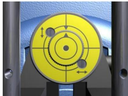
2. Ruotare la torretta sul lato statico e assicurarsi che il fascio laser colpisca lo stesso punto (con un margine di 2 mm). Altrimenti, regolare il laser incorporato secondo i passaggi 5-12.
