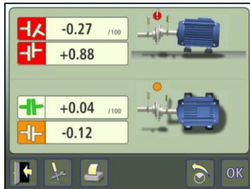
Quando si misura un accoppiamento, l'icona dell'allineamento alberi presso tale accoppiamento viene sostituita da un'icona di rimisurazione.
