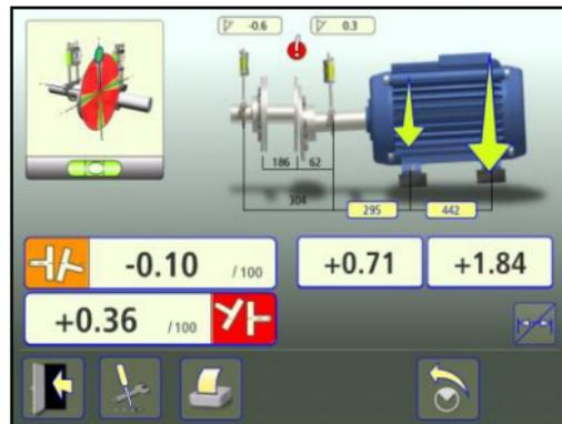
Ruotare gli alberi a ore 12 oppure ore 6 per effettuare le regolazioni in direzione verticale. La guida angolare è di ausilio per raggiungere la posizione corretta.
