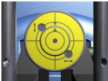
5. Verificare che il laser sia regolato rispetto al centro rotante ruotando la torretta su ogni staffaggio. Il fascio laser proiettato deve restare sullo stesso punto fisso durante la rotazione (con un margine di 2 mm). In caso contrario, regolare il fascio laser secondo la procedura descritta alla fine di questo capitolo.
