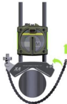
Fissare saldamente la catena utilizzando la vite di tensionamento. Se necessario, utilizzare l'apposito strumento di tensionamento in dotazione. Evitare il tensionamento eccessivo. Se il diametro dell'albero è troppo ampio, è possibile allungare le catene con le apposite prolunghe.
