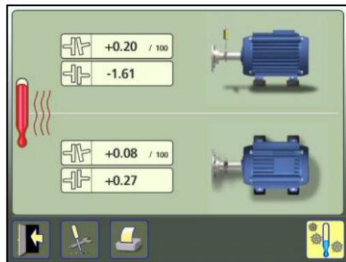
La schermata dei Risultati di misurazione mostra i valori dell'accoppiamento per la misurazione a caldo.
