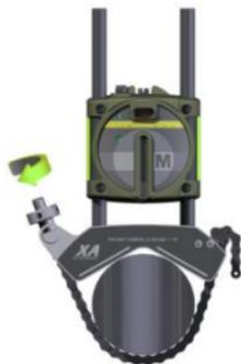
Regolare l'altezza del sensore facendolo scivolare lungo le aste fino ad ottenere una linea visiva per entrambi i laser. Fissarne la posizione serrando i due dispositivi di fissaggio posti nella parte posteriore dei due gruppi.
