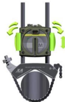
Il laser del sensore M può essere regolato con la vite di regolazione in cima all'unità. Normalmente non è necessario regolare il laser, tuttavia potrebbe rendersi necessario in fase di misurazione a grandi distanze.
