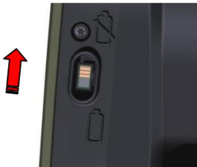
**NOTA!** Per lo spegnimento completo al fine di non scaricare la batteria, è necessario utilizzare l'interruttore di alimentazione sul retro della macchina.
