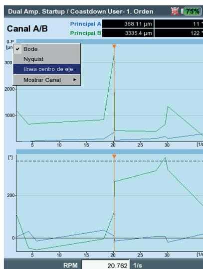
**Iniciar la medición y mostrar la trama de la línea central del eje**
