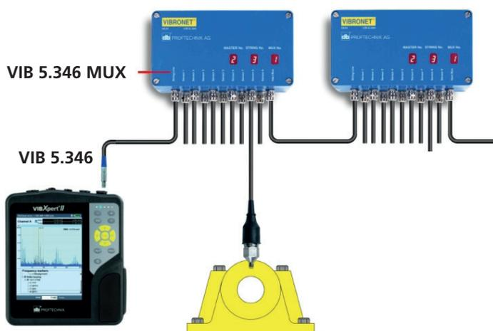
Es sind nur Schwingungsmessungen mit Beschleunigungsaufnehmer vom Typ Strom-Linedrive möglich.
