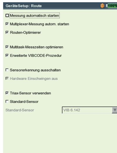
gungsaufnehmer gemessen werden sollen, sortiert VIBXPert diese aus und ordnet sie dem zweiten Messkanal zu.
