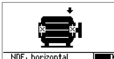
Position und Messrichtung an der Maschine
