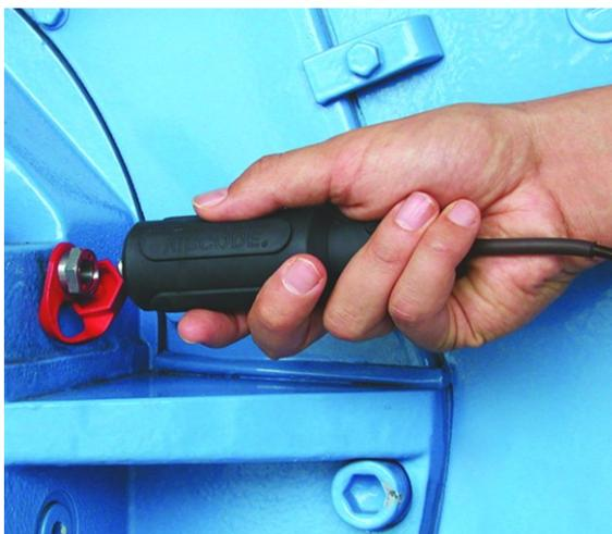
将 VIBCODE 传感器连接到 VIBCODE 测量位置。
