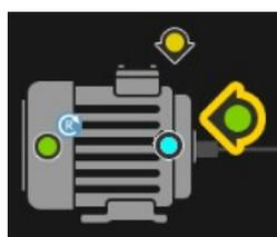
如果测量任务超出限制值，测量位置符号将显示颜色变化(红色、黄色、绿色)。
