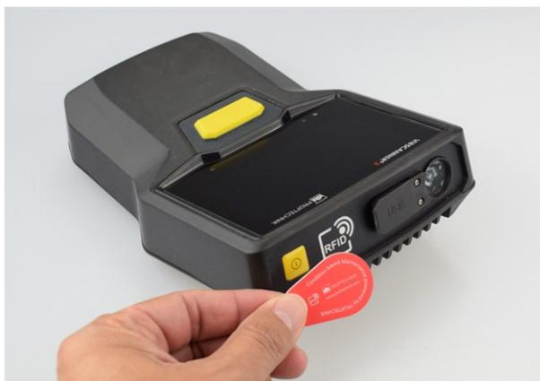
使用 RFID 技术( ISO 14443a 和 ISO 15693) 识别测量点。
