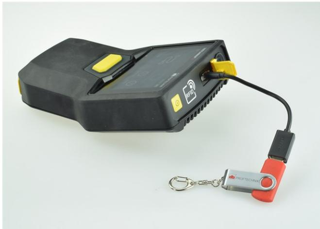
通过连接适配器将 USB 存储介质连接到 VIBSCANNER 2。
