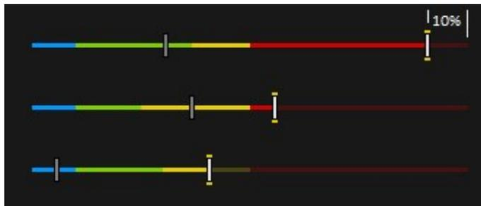
如果没有为测量设置限制，则条形图的缩放将预设为表中列出的值。如果测量值超出预设范围，则调整限值。然后，相关的测量值对应于显示范围的 **100%**。
