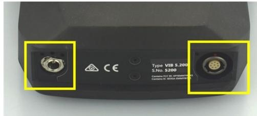
设备底部的充电插座(左)和多极模拟测量通道(模拟输入,右)。
