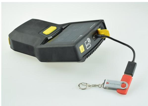
Conectar o dispositivo USB de armazenamento ao VIBSCANNER 2 com o adaptador de conexão.
