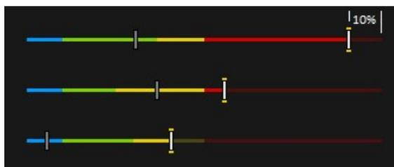
Se não houver **nenhum valor limite** predefinido para as medições, então a escala do gráfico de barras é determinada de acordo com os valores exibidos na tabela. Se uma medição ultrapassa da área predefinida, os limites são adaptados. O respectivo valor de medição corresponde então a **100 %** da faixa de exibição.
