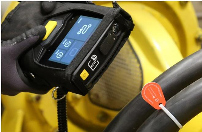
O módulo de leitura RFID capta a codificação do transponder sem contato direto.
