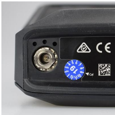
A placa indica o próximo prazo de verificação (aqui: 09-2019).
