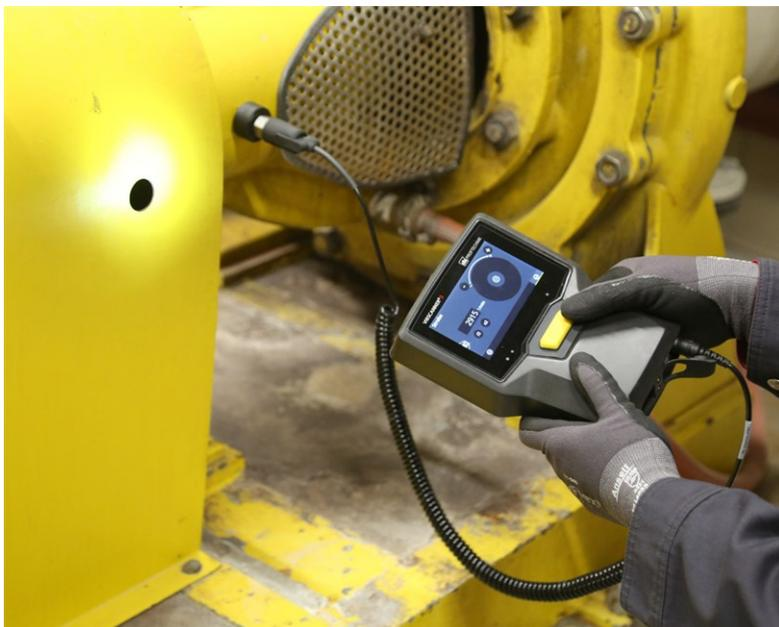
Direcionar o estroboscópio para o componente em rotação.
