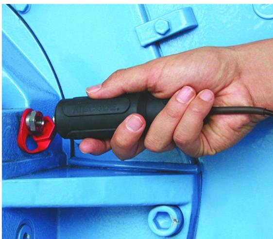
Conectar o sensor VIBCODE no ponto de medição VIBCODE.
