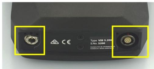
Conector de carregamento (à esquerda) e canal de medição analógico multipolar (entrada analógica, à direita) na parte inferior do dispositivo.
