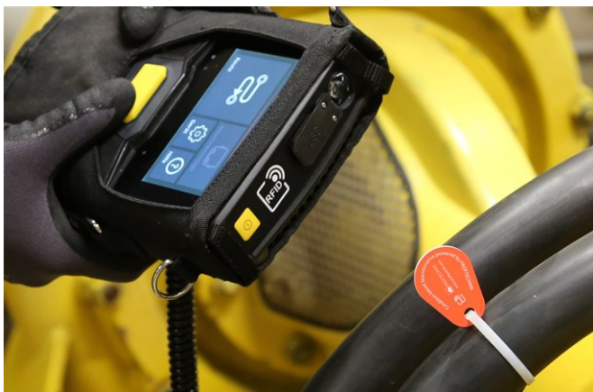
Moduł czytnika RFID bezdotykowo wykrywa kodowanie transpondera.
