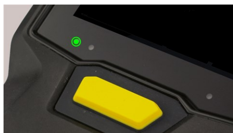
Wskaźnik poziomu naładowania LED w trybie uśpienia.
