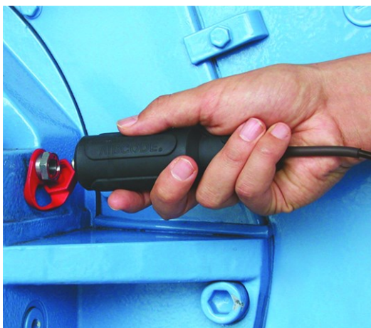
Podłącz czujnik VIBCODE do punktu pomiarowego VIBCODE.
