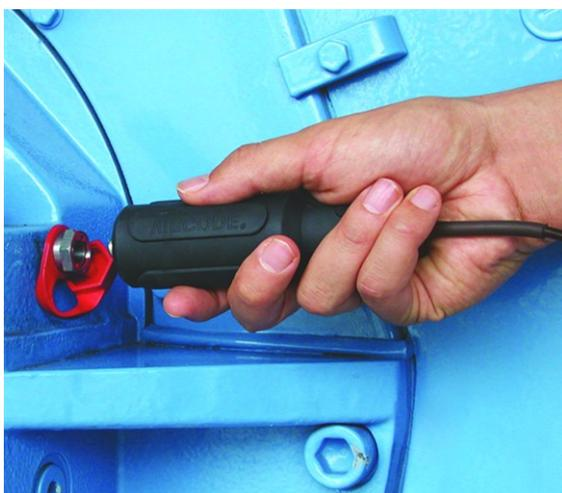
VIBCODEセンサーをVIBCODE測定ロケーションに接続する。
