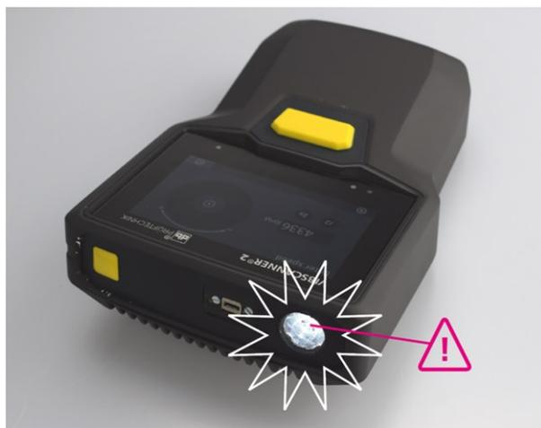
ストロボスコープを使ってスピードを検証する。
