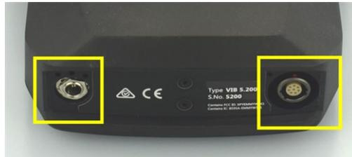
デバイス下側の充電ソケット(左)と複数のピンが付いているアナログの測定チャンネル(アナログIN、右)。
