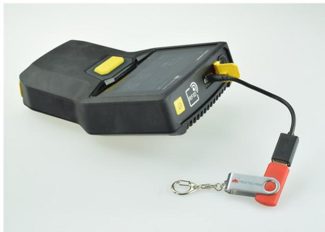
接続アダプターを使ってUSB外部記憶メディアをVIBSCANNER 2に接続します。
