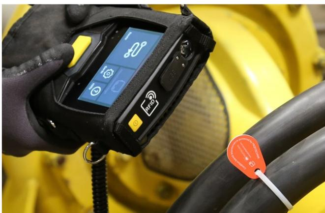
RFIDリーダーモジュールがトランスポンダーのコーディングを非接触で収集します。
