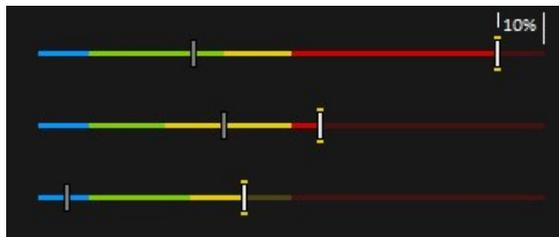
Se non è stato impostato **alcun valore di riferimento** per le misurazioni, la messa in scala degli istogrammi è preimpostata sui valori predefiniti nella tabella. Se una misurazione supera il settore preimpostato, i limiti sono adattati. Il valore di misurazione in oggetto corrisponde pertanto al **100 %** del settore di visualizzazione.
