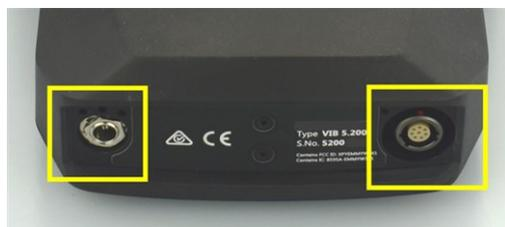
Preso di carica (sinistra) e canale di misurazione analogico multipolare (analogico IN, destra) sul lato inferiore dell'apparecchio.
