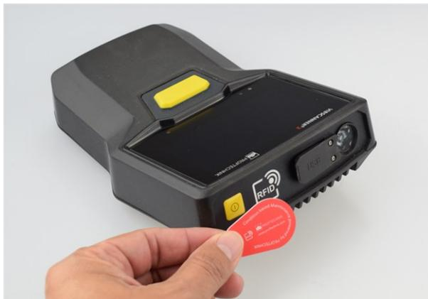
Identificare i punti di misurazione con tecnologia RFID (ISO 14443a e ISO 15693).
