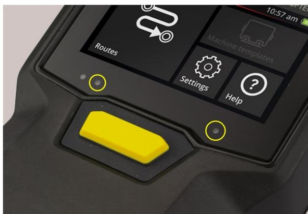
Due aperture d'ingresso per il sensore della luce ambiente.
