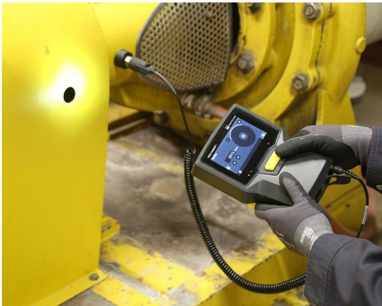
Orientare lo stroboscopio sui componenti rotanti.
