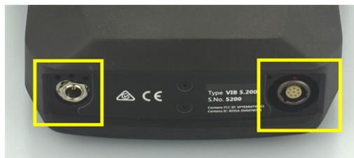
Port de charge (à gauche) et canal de mesure analogique multipolaire (entrée analogique, à droite) sur la face inférieure de l'appareil.
