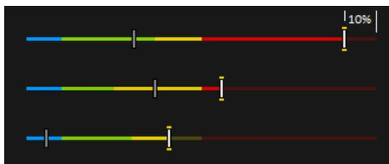
Si **aucune valeur limite** n'est configurée pour les mesures, la mise à l'échelle du diagramme en barres est préconfigurée sur les valeurs indiquées dans le tableau. Si une mesure dépasse la plage préconfigurée, les limites sont ajustées. La valeur de mesure concernée correspond alors à **100 %** de la plage d'affichage.
