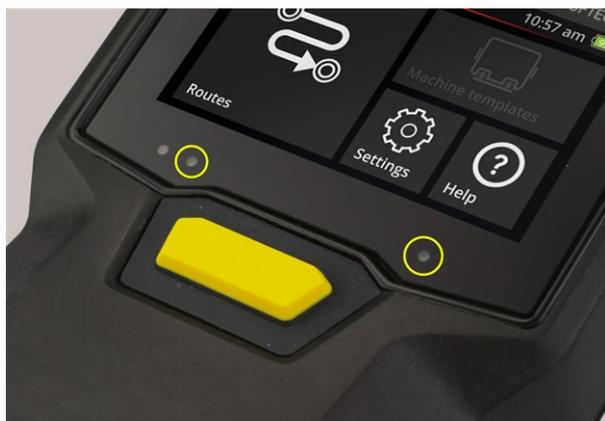
Dos orificios de entrada para el sensor de luz ambiente.
