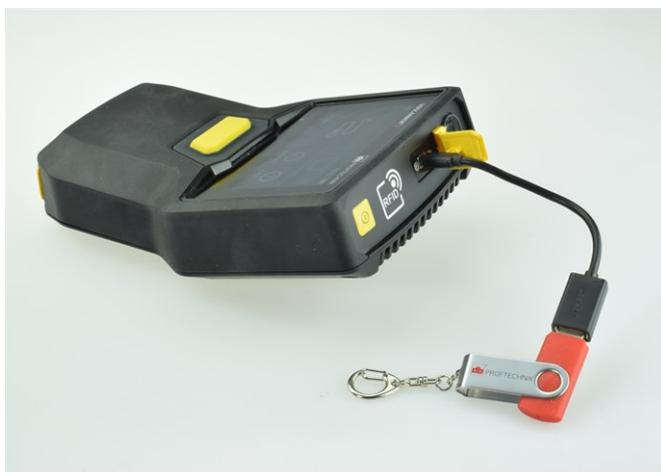
Dispositivo USB de almacenamiento conectado a VIBSCANNER 2 mediante un adaptador de conexión.
