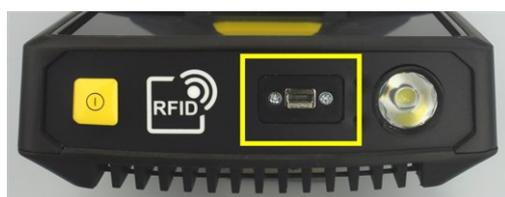
Conexión micro-USB para intercambiar datos.
