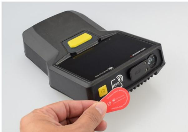
Identificación de puntos de medición mediante la tecnología RFID (ISO 14443a y ISO 15693).
