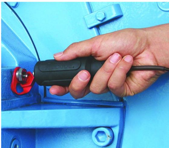
Conexión del sensor VIBCODE a un punto de medición VIBCODE.
