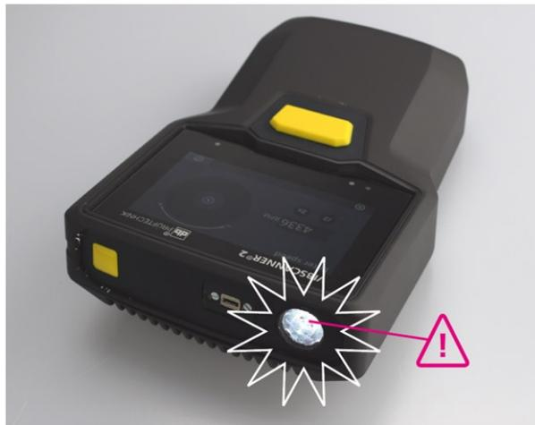
Drehzahl verifizieren mit Stroboskop.
