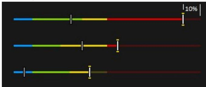
Wenn **keine Grenzwerte** für die Messungen eingerichtet sind, dann ist die Skalierung auf die in der Tabelle aufgeführten Werte voreingestellt. Überschreitet eine Messung den voreingestellten Bereich, werden die Grenzen angepasst. Der betreffende Messwert entspricht dann **100 %** des Anzeigebereiches.
