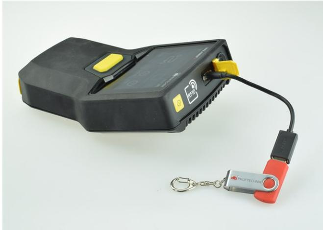
USB-Speichermedium mit Anschlussadapter am VIBSCANNER 2 angeschlossen.
