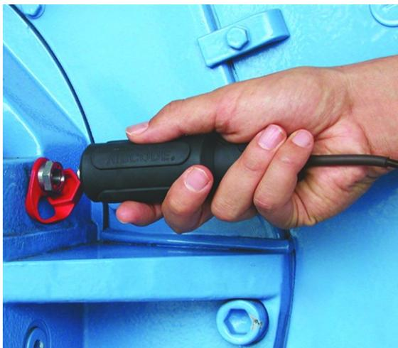
VIBCODE-Sensor an VIBCODE-Messstelle anschließen.
