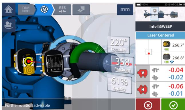
Depois de girar os eixos através de um ângulo mais amplo possível, toque em
