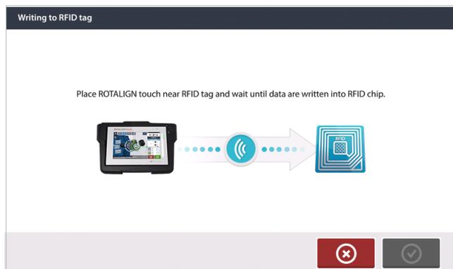
Posicione o ROTALIGN touch de modo que seu módulo NFC integrado fique o mais próximo possível da etiqueta RFID (menos de um centímetro).
