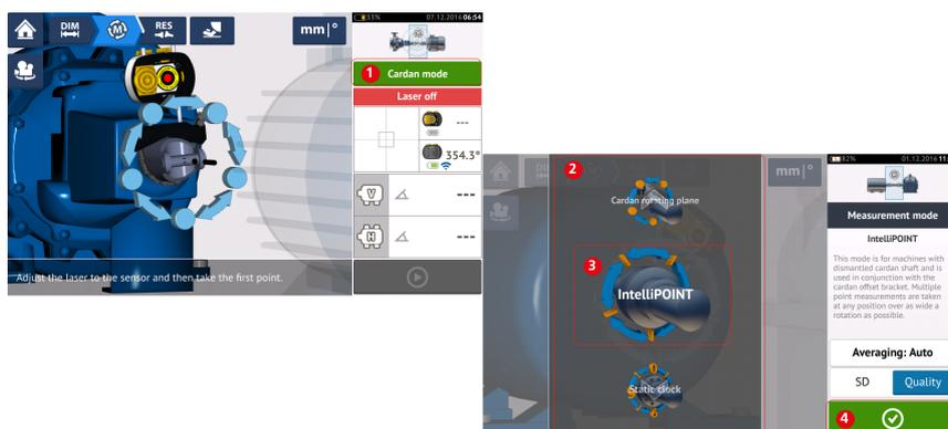
3. Toque em **1** para acessar a tela 'Measurement mode' (Modo de medição).
