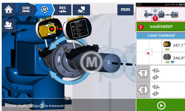
O **modo de medição** usado na medição do acoplamento neste exemplo é **IntelliSWEEP**.
