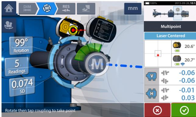
Quando a medição em ambos os acoplamentos estiver completa, toque em
