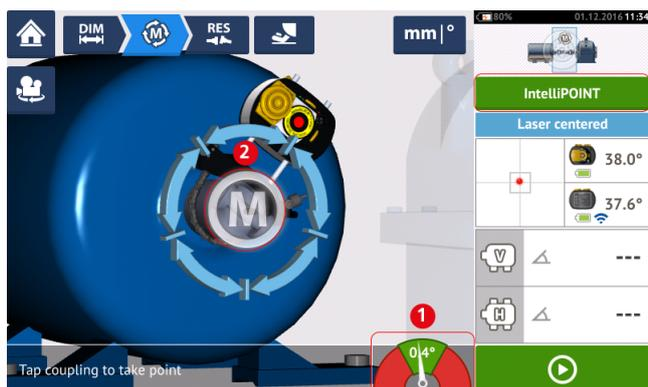
1. Com o feixe de laser centralizado e a agulha exatamente no centro do setor verde (1), aguarde a estabilização da medição.
