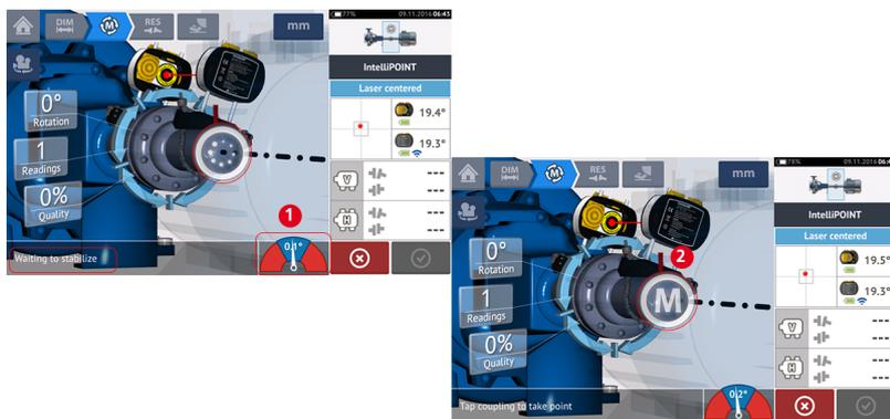
Gire qualquer uma das cabeças para a próxima posição de medição; repita o procedimento para tomar medidas em pelo menos três posições em pelo menos 60° de rotação; entretanto, é recomendável tomar mais medições em um ângulo maior.
