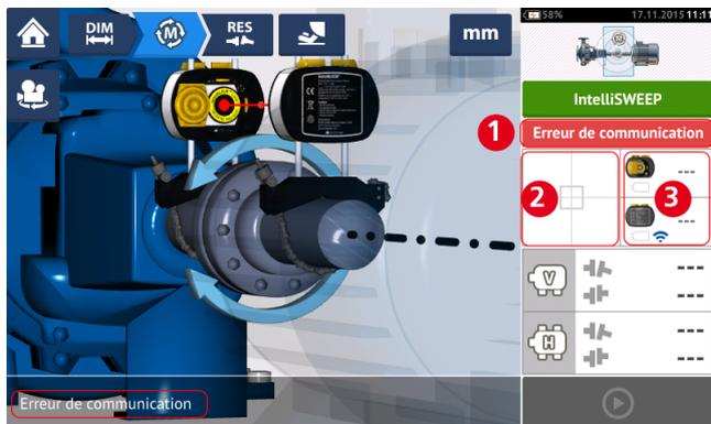
Toque na área do detector [2] ou na área do sensor/laser [3] para acessar o item do menu "Lista do sensor".
