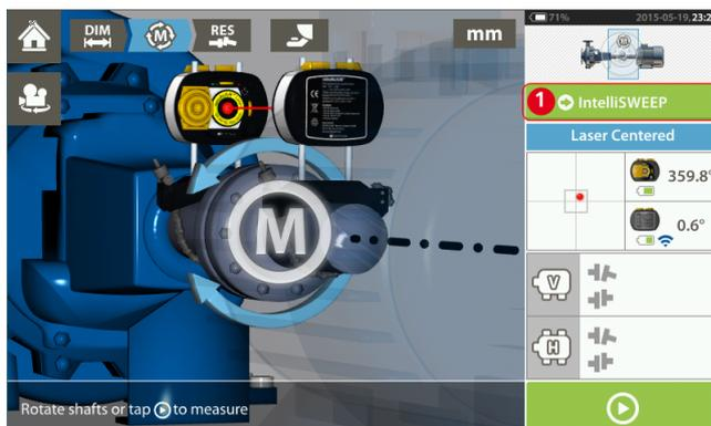
Toque no cabeçalho do modo de medição [1] para acessar o carrossel do modo de medição.
