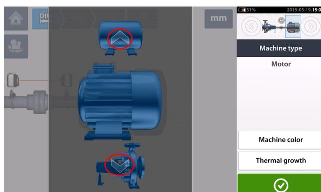
Deslize para cima ou para baixo no carrossel da máquina (ou toque na seta para cima ou para baixo) para selecionar a máquina desejada. Posicione a máquina desejada no centro do carrossel, em seguida toque em
