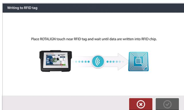
Posizionare ROTALIGN touch in maniera tale che il suo modulo NFC integrato sia più vicino possibile al tag RFID (meno di 1 cm).
