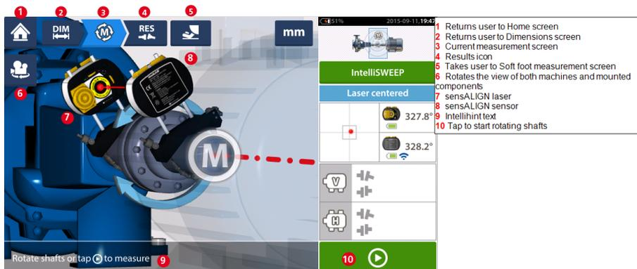
Una volta centrato il raggio laser, la misurazione può essere avviata automaticamente quando gli alberi sono ruotati o toccando
