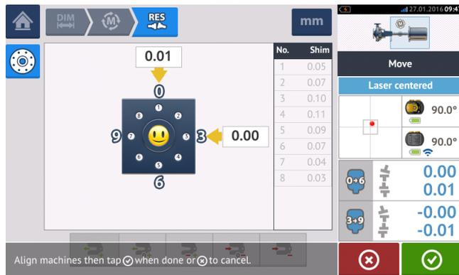
6. Non appena lo spostamento rientra nelle tolleranze, serrare i bulloni della flangia. Eseguire una nuova misurazione per verificare che la nuova condizione di allineamento rientri nelle tolleranze.
