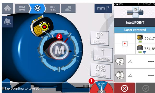
6. Una volta stabilizzata la misurazione, sfiorare 'M' (2) per acquisire la misurazione.
