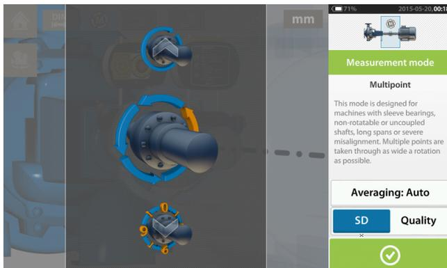
Nell'esempio mostrato sopra è stata selezionata la misurazione **Multipoint**. La qualità della misurazione può essere visualizzata come deviazione standard dalla misurazione (SD) o fattore qualitativo della misurazione. Il fattore desiderato è definito toccando la voce corrispondente. La media è definita toccando il tasto 'Media'.
