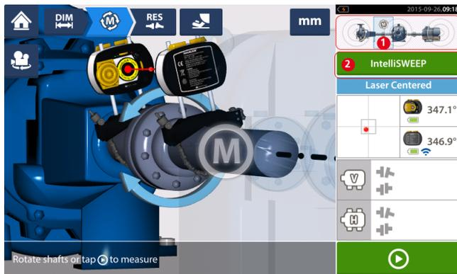
La **modalità di misurazione** utilizzata per la misurazione del giunto in questo esempio è **IntelliSWEEP**.
