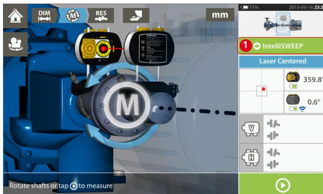
Toccare l'intestazione della modalità di misurazione [1] per accedere al carosello della modalità di misurazione.
