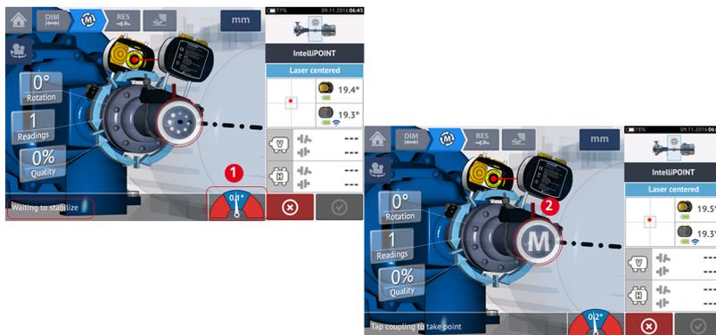
Ruotare ciascuna delle testine nella posizione di misurazione successiva; ripetere la procedura per acquisire le misurazioni attraverso almeno tre posizioni su un angolo di rotazione pari ad almeno  $60^\circ$ , ma si raccomanda di acquisire più misurazioni su un angolo più ampio.
