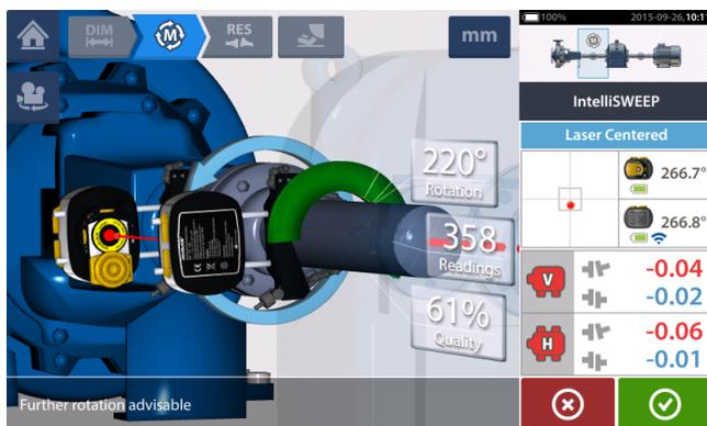
Dopo aver ruotato gli alberi attraverso l'angolo più ampio possibile, toccare
