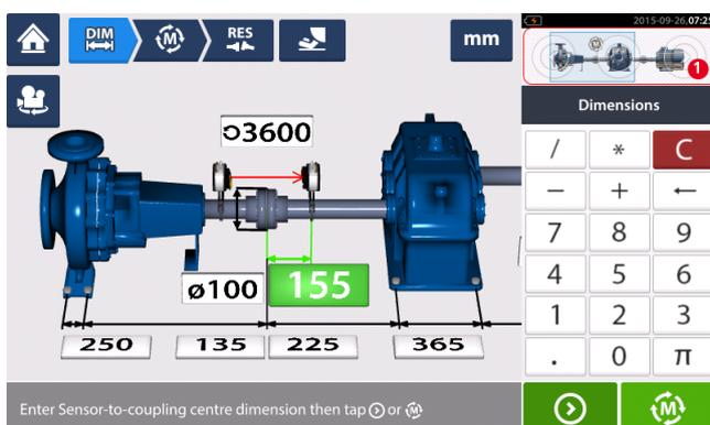
Per visualizzare l'intero treno a tre macchine e le relative dimensioni, toccare il centro del mini-riquadro del treno [1] per accedere alla schermata "Gestione treno macchina".
