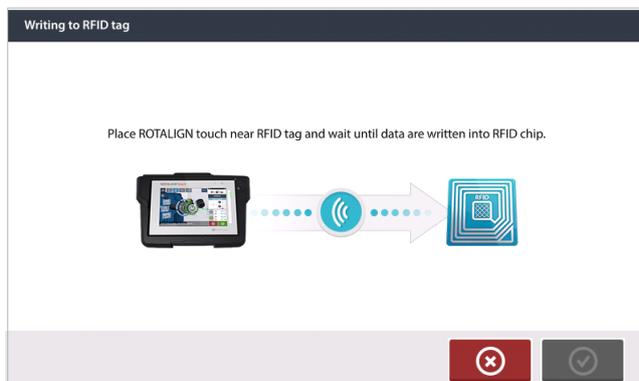
Positionnez ROTALIGN touch de sorte que son module NFC intégré soit le plus près possible de l'étiquette RFID (moins d'un centimètre).
