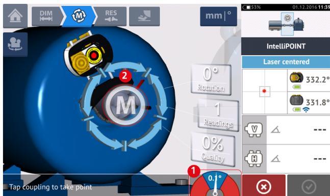
6. Une fois la mesure stabilisée, appuyez sur 'M' (2) pour prendre la mesure.
