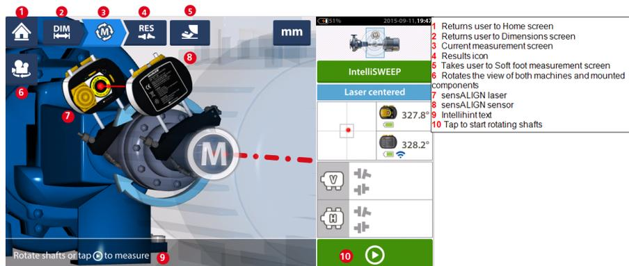
Une fois le faisceau laser centré, la mesure peut être automatiquement lancée avec la rotation des arbres ou en appuyant sur
