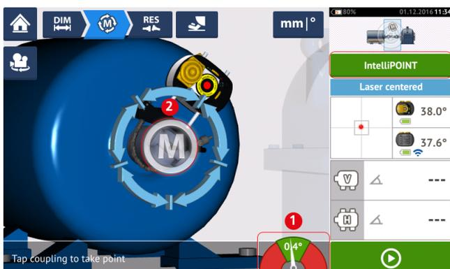
1. Avec le faisceau laser centré et l'aiguille parfaitement au centre de la zone verte (1), patientez le temps que la mesure se stabilise.
