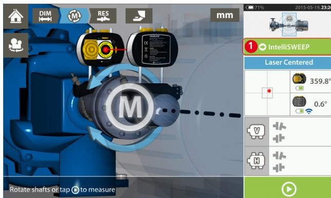
Appuyez sur l'entête du mode de mesure [1] pour accéder au carrousel des modes de mesure.
