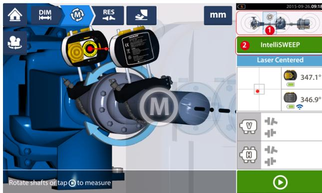
Le **mode de mesure** utilisé pour mesurer l'accouplement dans cet exemple est **IntelliSWEEP**.
