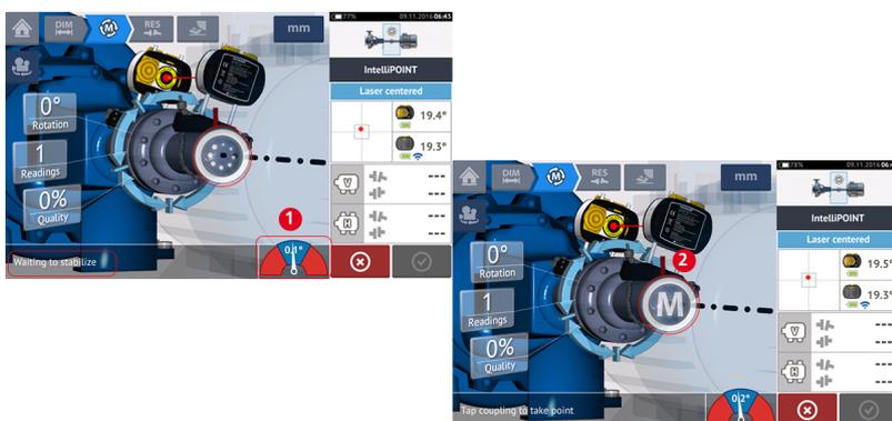
Faites tourner chacune des têtes vers le point de mesure suivant ; répétez la procédure pour prendre des mesures à trois positions au moins sur un angle de rotation minimal de 60°. Il est toutefois recommandé de prendre plus de mesures sur un angle plus large.
