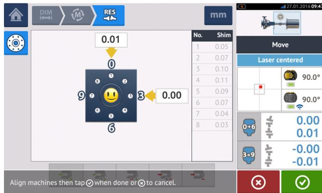
6. Cuando el desplazamiento se encuentre dentro de tolerancia, apriete los pernos de la brida. Realice de nuevo la medición para comprobar si el nuevo estado de alineación está dentro de las tolerancias.
