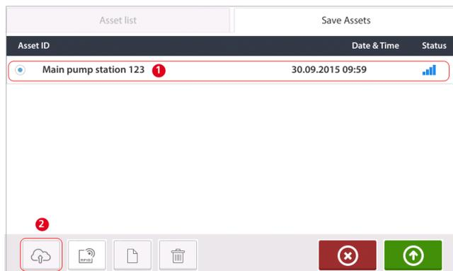
Toque el icono "Subir" (2) El archivo de medición aparecerá en la vista "Intercambio" de ARC 4.0 con el estado "completado". Arrastre y suelte el archivo de medición hasta su ubicación correspondiente en Cloud drive.
