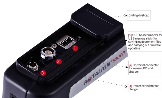
El ordenador ROTALIGN touch posee una batería interna recargable, la cual se carga conectando el ordenador ROTALIGN touch a la red eléctrica a través del cargador/adaptador suministrado. El cargador/adaptador se conecta al conector de alimentación (véase la imagen más
