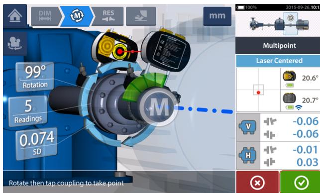
Cuando la medición a lo largo de ambos acoplamientos se haya completado, toque
