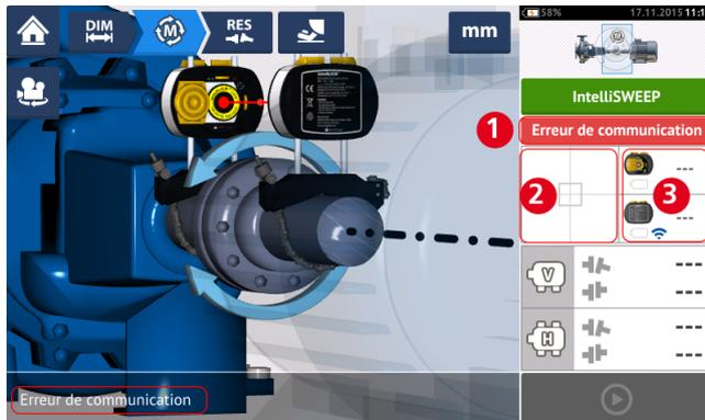
Toque el área del detector [2] o el área del sensor/láser [3] para acceder al elemento de menú '[Lista de sensores](#)'.
