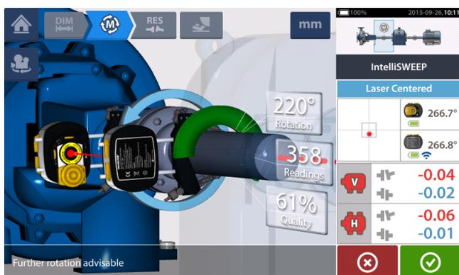
Tras girar los ejes en un ángulo lo más amplio posible, toque
