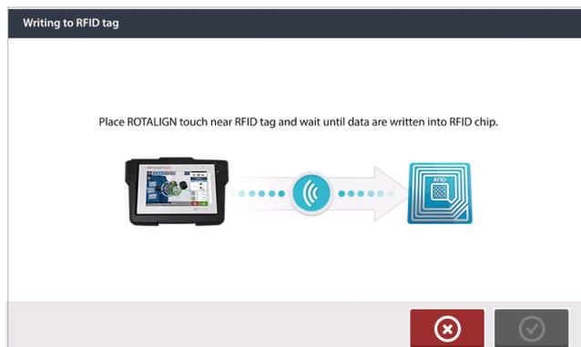
Posicione ROTALIGN touch de tal modo que su módulo NFC integrado se encuentre tan próximo a la etiqueta RFID como sea posible (menos de un centímetro).
