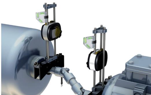
Les supports sont positionné sur le même angle de rotation à l'aide des inclinomètres externes.
