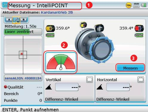
In diesem Beispiel wird die Kardan Messvorrichtung ALI 2.893 SETIS verwendet. Das System wählt den IntelliPOINT Messmodus. Um die Nadel zu zentrieren müssen sich Laser und Sensor im selben Drehwinkel befinden.
