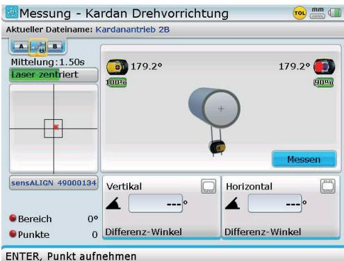
Die Schaltfläche „Messen“ erscheint erst, wenn der Laserstrahl auf den Detektorbereich des Sensors trifft und sich die Messwerte stabilisiert haben.
