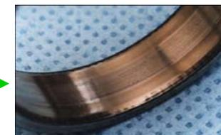
Anello esterno di un cuscinetto a sfere con le guide usurate da particelle abrasive
