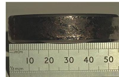
Nota: si parla di corrosione anche nel caso di sfregamento, ossia di micro-movimenti, tra due superfici caricate (*fretting corrosion*).
