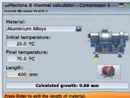
Utilizzato per determinare matematicamente i parametri di espansione termica della macchina.
