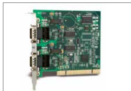
Foto 1: 2 slot PCI/PCIe nella versione H3
