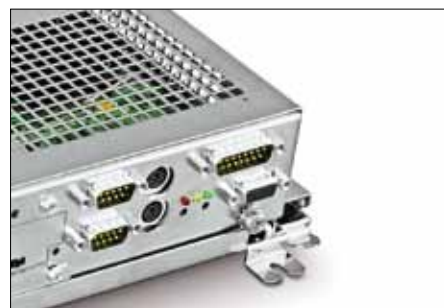
Foto 1: 2 slot PCI/PCIe nella versione H3
