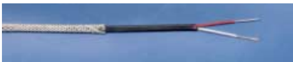
Isolamento primario in teflon isolamento secondario in teflon Schermo in calza di rame stagnato Colorazione a norme ANSI MC96.1
