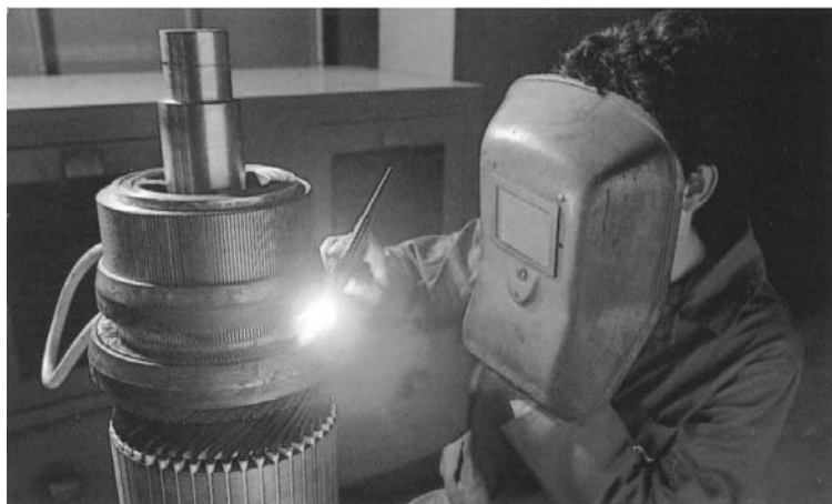
Saldatura rotore con metodo TIG
