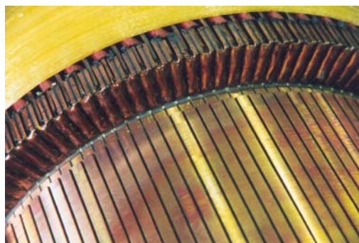
Soudage particulier des conducteurs au collector, type T. I. G.
