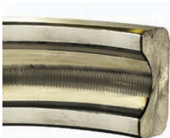
Il fluting: ondulazione della superficie della pista
