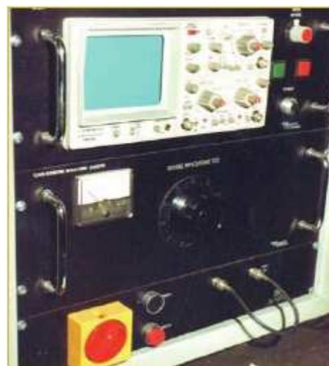
Surge-test per il Collaudo delle Macchine Elettriche
