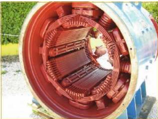
Motore C.C. 1500 Kw. 600 Volts dopo riparazione al forno
