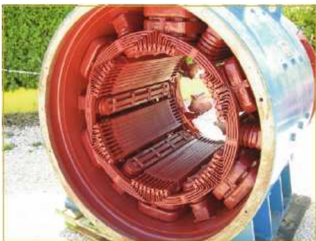
Motore C.C. 1500 Kw. 600 Volts dopo ripara-zione al forno
