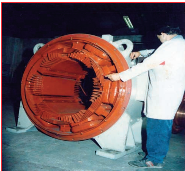
Verificarea motorului Marelli de 700 CP
