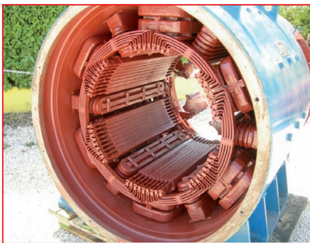
Motor C.C. 1500 Kw. 600 Volți dupa uscare în cuptor TEST CIRCULAR
