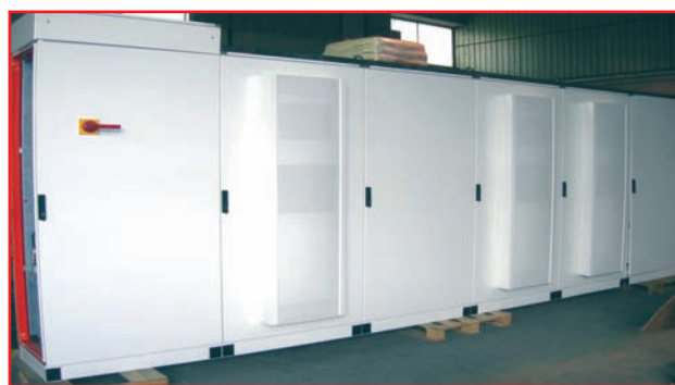
Panou de control pentru linia de taiere a foilor de metal Fiat Cassino – Centru Prese (29 tone de structuri metalice– trei PLC S7-300 319F in retea – opt panouri de operare – 32 unitati in retea – cincizeci si cinci de encodare pentru pozitionare - aproximativ 2200 I/O)
