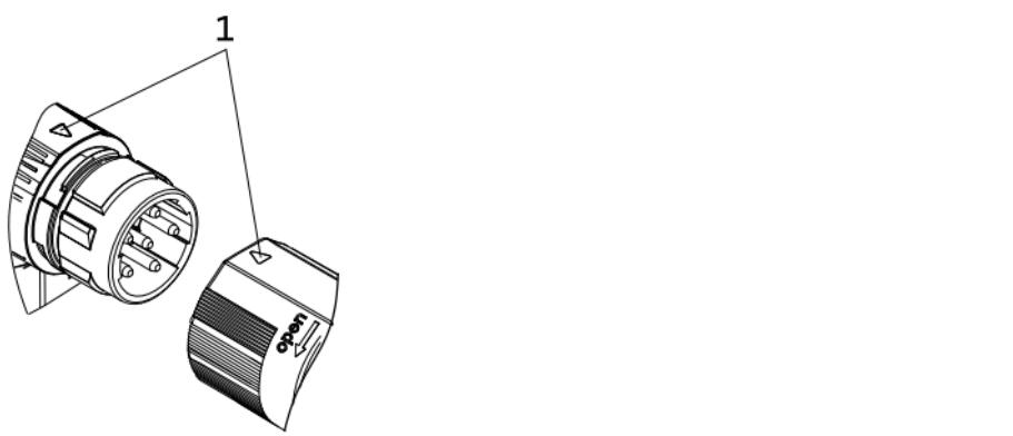
Al unir el conector enchufable del cable con el conector del motor observar que la ayuda para la orientación (pos. 1) se encuentre justo delante. Sólo así se puede asegurar un funcionamiento sin fallos.
