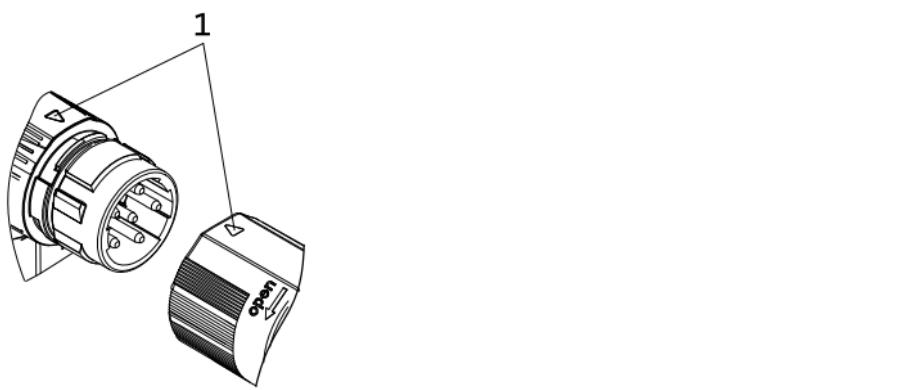
Beim Zusammenstecken des Kabel-Steckverbinder mit dem Motorstecker darauf achten, dass die Orientierungshilfe (Pos.1) gegenüberliegen. Nur so ist ein störungsfreier Betrieb gewährleistet.
