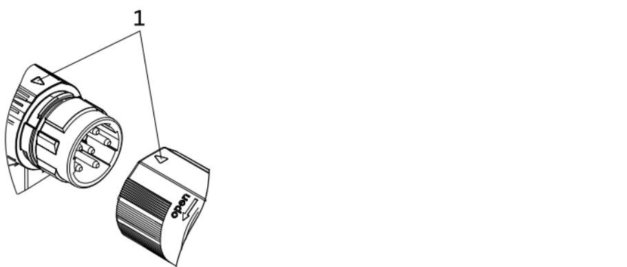
En reliant le connecteur femelle côté câble et le connecteur mâle côté moteur, veiller à ce que les points de repère se situent face à face (Pos. 1). C'est la condition minimum requise pour assurer une bonne connexion.
