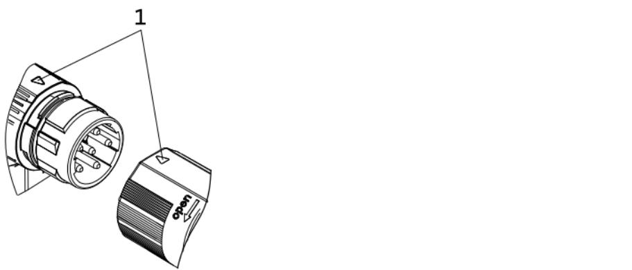
Nel congiungere il connettore ad innesto del cavo con il connettore motore, assicurarsi che le tacche di orientamento (pos.1) combacino. Solo così è possibile assicurare un funzionamento senza problemi.
