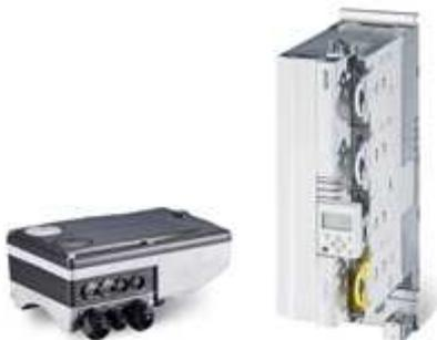
L'inverter è un convertitore statico che genera una tensione a frequenza ed ampiezza variabile in funzione di una regolazione esterna. A frequenza nominale raggiunge la piena tensione (*quella di rete*) mantenendo costante la coppia, l'ulteriore aumento di frequenza senza l'incremento proporzionale della tensione, consente di raggiungere velocità maggiori con un indebolimento però del flusso magnetico e di conseguenza con
